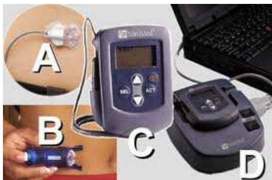
Εικόνα 2.3: Διάταξη Συνεχούς Καταγραφής Γλυκόζης , GlucoWatch [25].
