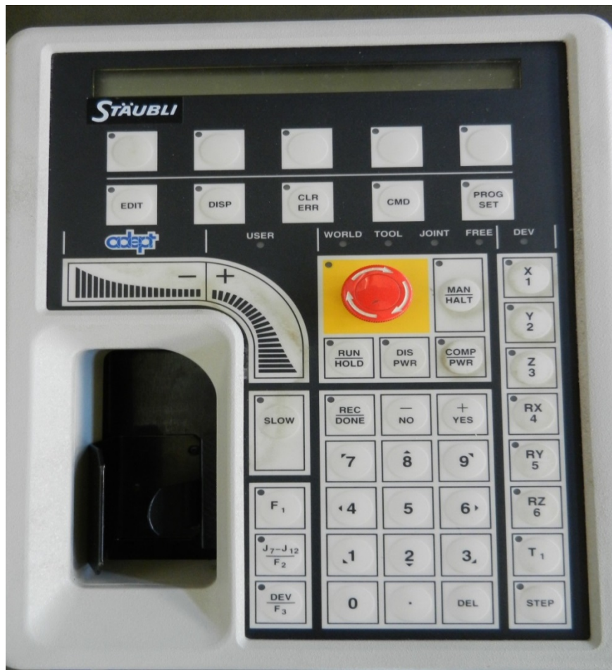
Εικόνα 2.8: Χειριστήριο ρομποτικού βραχίονα Staubli RX90L
