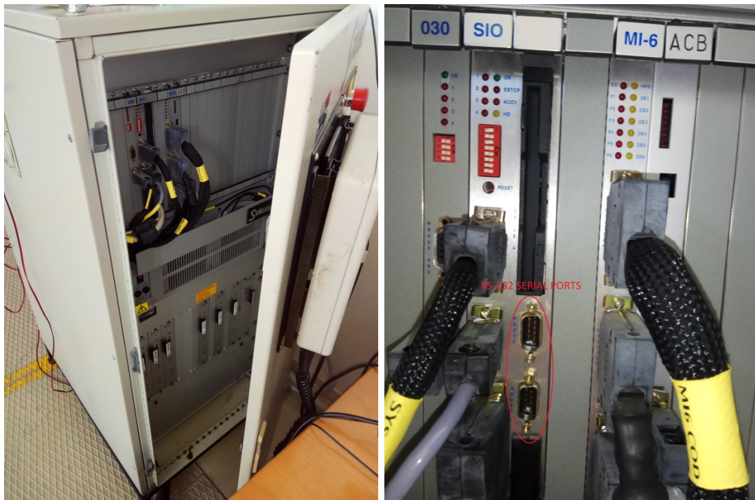
Εικόνα 8.2 : (α) Το μπροστινό μέρος του ελεγκτή του ρομποτικού βραχίονα (β) Οι σειριακές θύρες RS - 232
