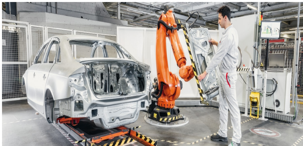
Εικόνα 1.6 : Παράδειγμα συνεργασίας Ανθρώπου Ρομπότ στη συναρμολόγηση (Audi)
