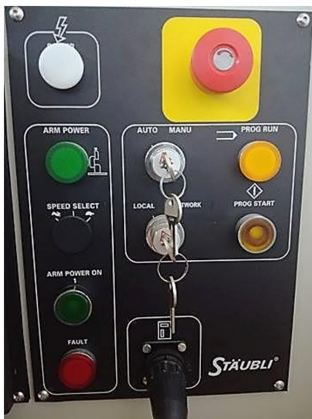
Εικόνα 2.7: Μπροστινό πάνελ του ελεγκτή
