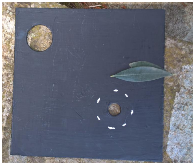
Εικόνα 16: Η επιφάνεια plexiglass που χρησιμοποιήθηκε κατά τις επίγειες μετρήσεις ανακλαστικότητας (Πηγή: Προσωπικό αρχείο)
