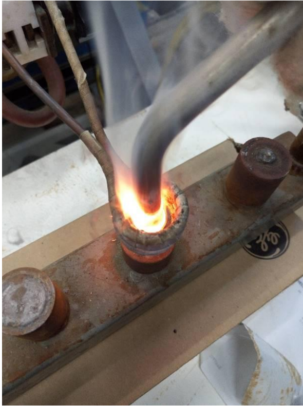
Εικόνα 25: Στα 6sec της συγκόλλησης brazing
