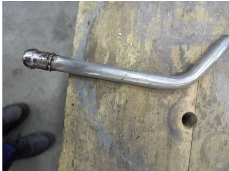
Εικόνα 17: Τοποθέτηση filler πριν το brazing
