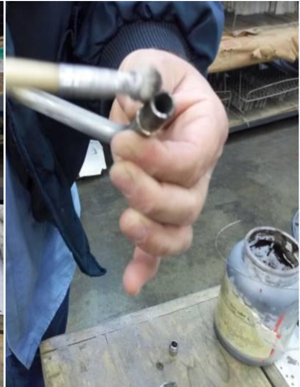
Εικόνα 19: Τοποθέτηση συλλιπάσματος πριν την έναρξη brazing
