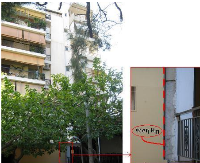
ΕΙΚΟΝΑ 6. Η Θέση της Υψομετρικής Αφετηρίας R_{\Pi} στην Πολυκατοικία της Οδού Κουσίδου.
