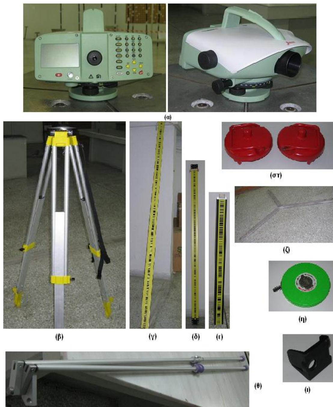
ΕΙΚΟΝΑ 7. Ο Ψηφιακός Χωροβάτης DNA03 της Leica και τα Παρελκόμενά του.
