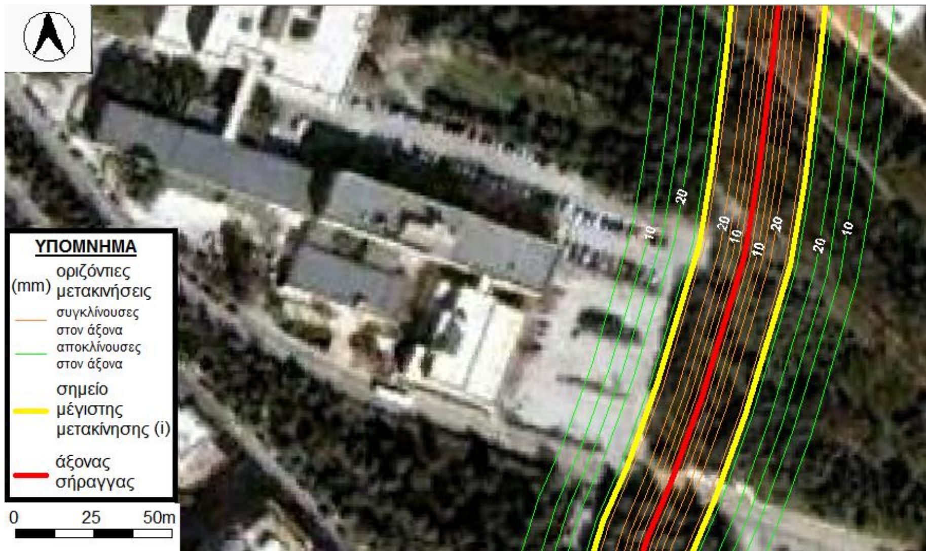
ΧΑΡΤΗΣ 6. Καμπύλες Ίσων Οριζόντιων Μετακινήσεων στην Περιοχή Μελέτης. [23]
