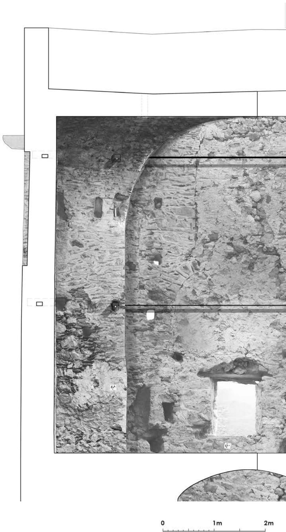
εικ. 84, ορθοεικ., πρόταση αποκατάστασης, Τομή ΒΒ
