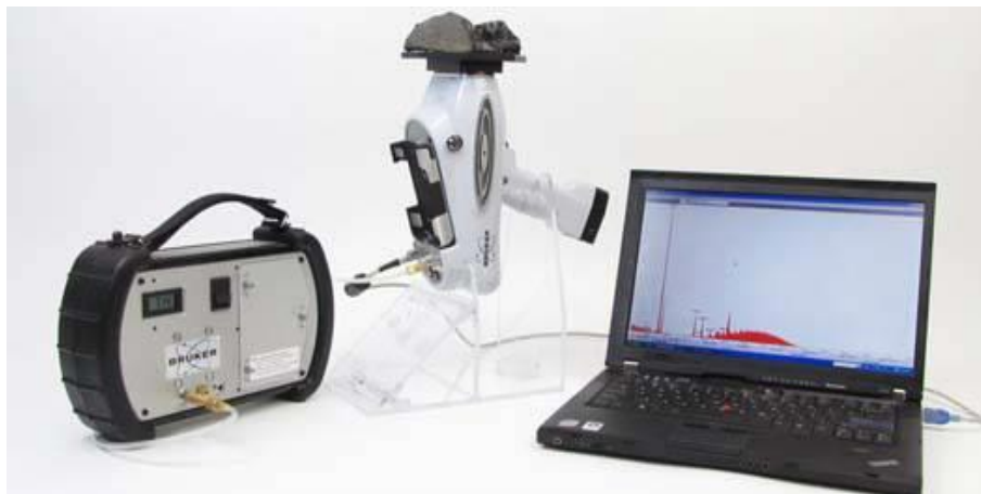
Εικόνα 2-4 Φορητή συσκευή XRF τύπου Tracer III-V της Bruker-AXS [89]
