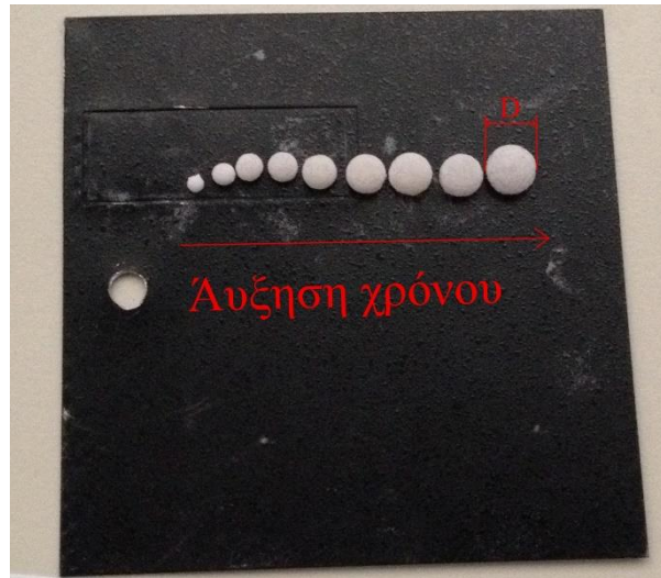
Σχήμα 5.5: Η κάτοψη μιας σειράς αποτελεσμάτων πειραμάτων στατικής κεφαλής Χρόνου – Μεγέθους. Η πλευρά που έπεφτε η δέσμη laser δεν φαίνεται. Παρατηρείται η αύξηση της διάστασης D με το πέρασμα του χρόνου θέρμανσης από την δέσμη laser.
