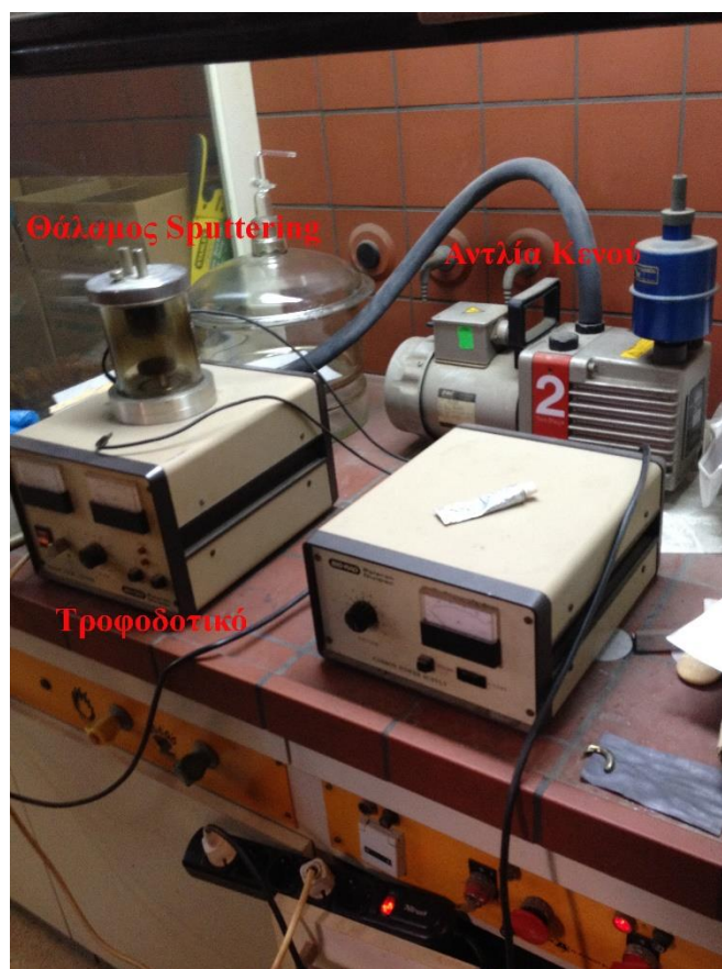
Σχήμα 5.30: Κύκλωμα για την δημιουργία sputtering.
