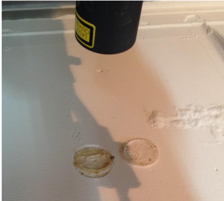
Σχήμα 5.87: Κυκλικός δίσκος με F = 0.5 \text{ mm/s} (αριστερά) και F = 0.9 \text{ mm/s} (δεξιά). Η διαφορά στην μορφολογία λόγω των παραμορφώσεων είναι εμφανής.
