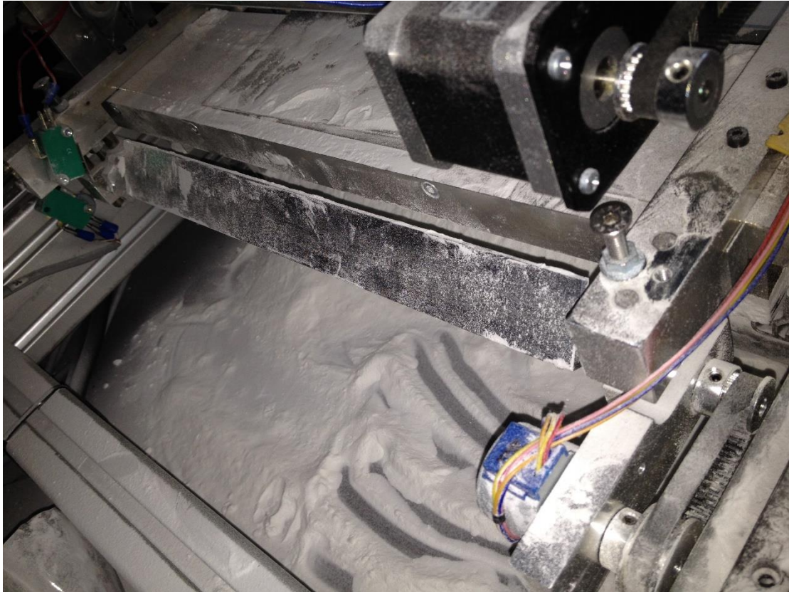
Σχήμα 4.17: Ο αριστερός doser του συστήματος απλώματος σκόνης δεν έχει στραφεί στην σωστή του θέση μετά το ρίξιμο της σκόνης.
