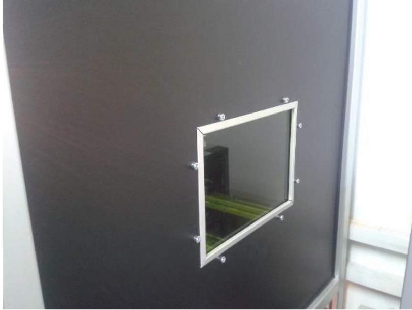
Σχήμα 2.17: Τζάμι P1K03 για την προστασία των ματιών και του δέρματος κατά την επίβλεψη της λειτουργίας της μηχανής.
