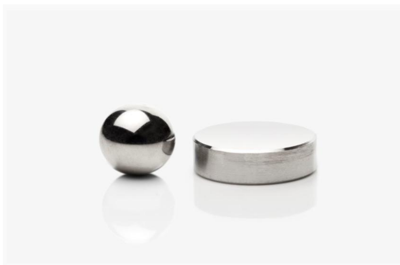
Εικόνα 12: Άνω σφαιρικό δοκίμιο και κάτω επίπεδο δοκίμιο. [72]
