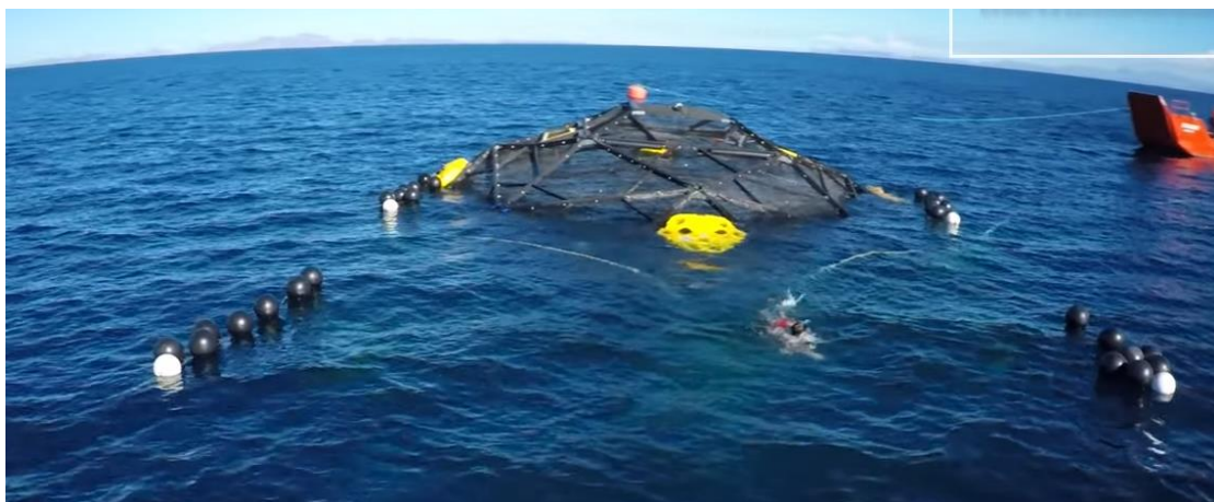
Εικόνα 2.42: Σφαιρικός ιχθυοκλωβός από πολυαιθυλένιο. Πηγή: www.livingoceanproductions.com
