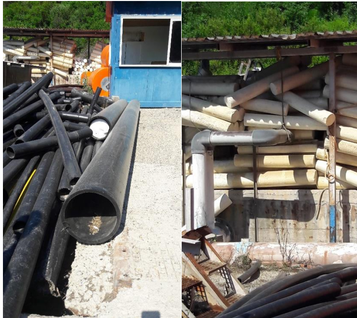
Εικόνα 2.4: Σωλήνες πολυαιθυλενίου HDPE και φελιζόλ
