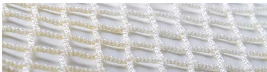
Εικόνα 2.9: Δίκτυο συνδυασμού πολυαιθυλαινίου και νάυλον
