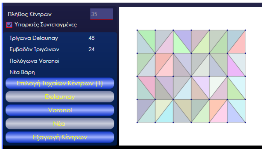
Εικόνα 3.11: Παράδειγμα τριγωνισμού Delaunay στον κάρναβο
