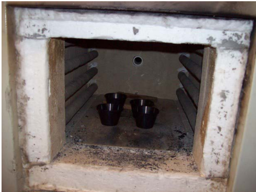
ΣΧΗΜΑ 5.4: Καύση δοκιμίων σε φούρνο.
