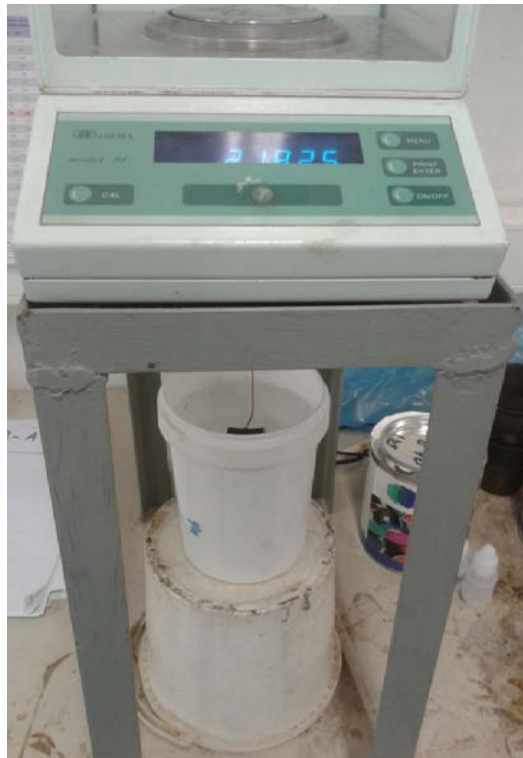
ΣΧΗΜΑ 5.2: Μέτρηση της μάζας δοκιμίου στο νερό.
