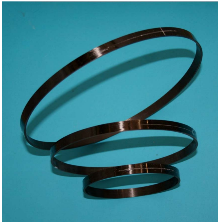
ΣΧΗΜΑ 3.2: Δοκίμια με εσωτερική διάμετρο 100, 150 και 200mm.
