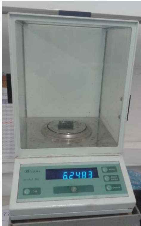
ΣΧΗΜΑ 5.1: Μέτρηση της μάζας δοκιμίου στον αέρα.
