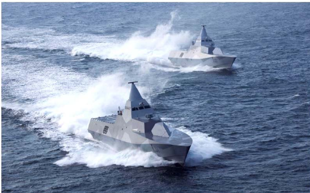
ΣΧΗΜΑ 1.10: Κορβέτες τύπου Visby του σουηδικού πολεμικού ναυτικού, κατασκευασμένες από σύνθετα ελάσματα τύπου sandwich με πυρήνα αφρού PVC και περιβλήματα από υβριδικά φύλλα άνθρακα-γυαλιού.
