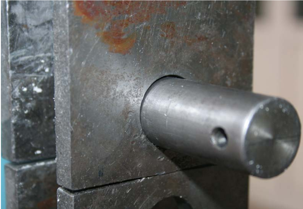
ΣΧΗΜΑ 4.15: Φαινόμενο πλαστικοποίησης στην οπή της διάταξης.
