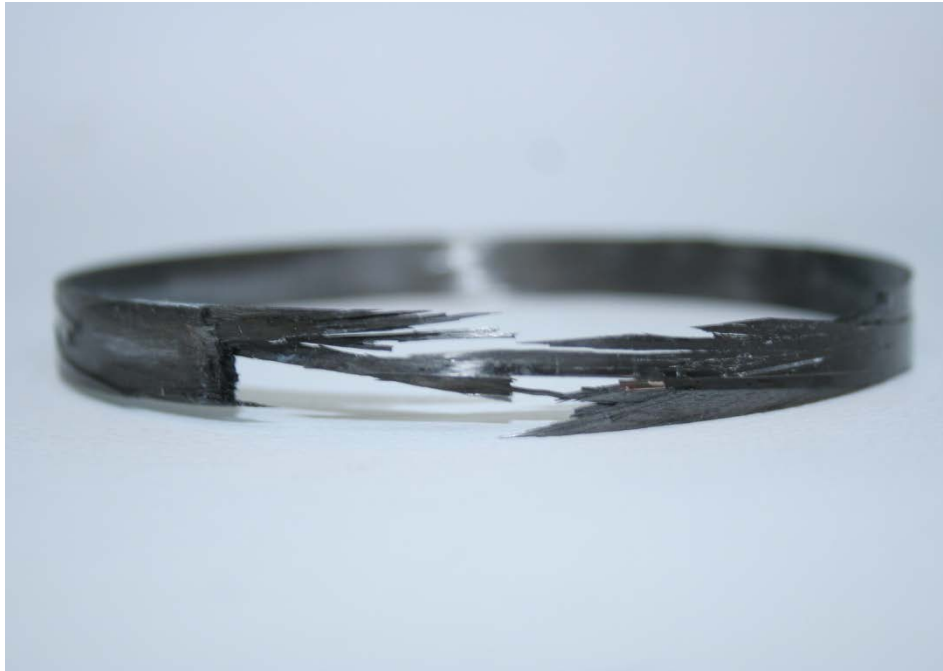
ΣΧΗΜΑ 5.35: Τυπικός τρόπος αστοχίας δοκιμίου στο οποίο η θραύση των ινών είναι ο κυρίαρχος τρόπος αστοχίας.
