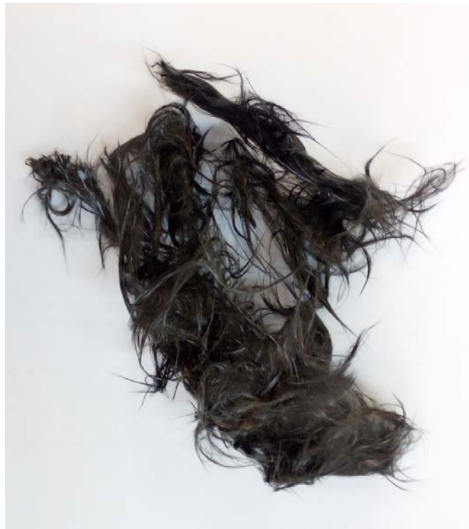
ΣΧΗΜΑ 5.3: Δοκίμιο από ενισχυτικές ίνες άνθρακα μετά την χημική προσβολή.
