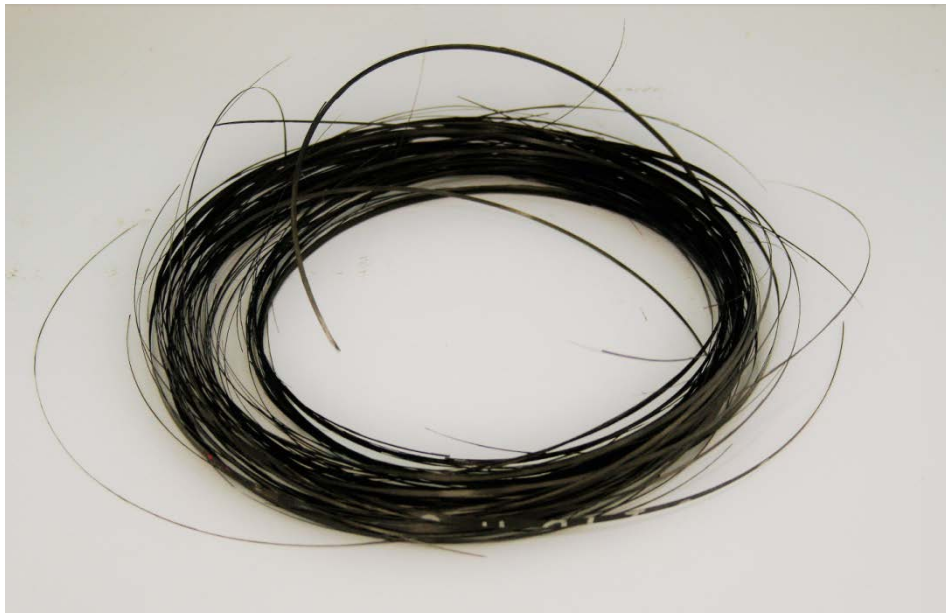
ΣΧΗΜΑ 5.37: Τυπική αποσύνθεση δοκιμίου.
