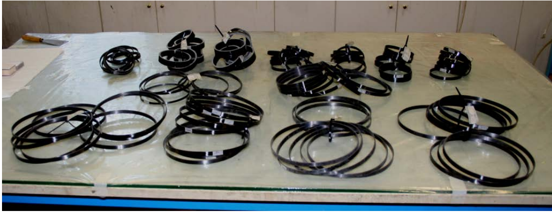
ΣΧΗΜΑ 3.1: Γενική όψη των δοκιμίων ταξινομημένων σε ομάδες με βάση τα γεωμετρικά και κατασκευαστικά τους χαρακτηριστικά.
