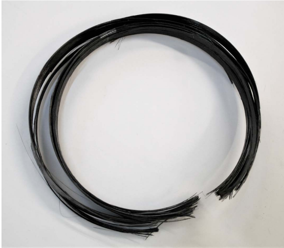
ΣΧΗΜΑ 5.36: Τυπικός τρόπος αστοχίας δοκιμίου στο οποίο η θραύση ινών ακολουθείται από delamination.
