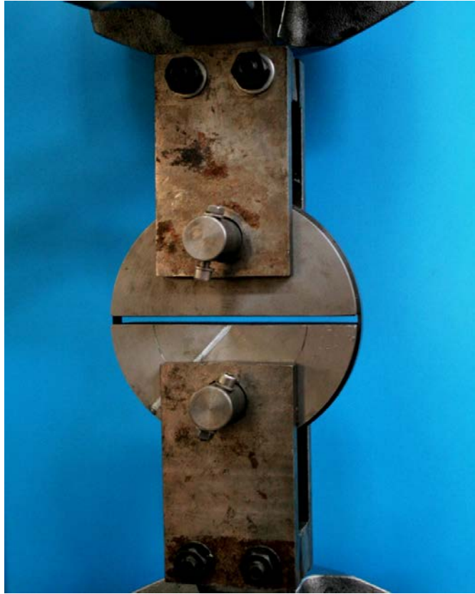
ΣΧΗΜΑ 4.11: Γενική όψη της διάταξης διαιρούμενου δίσκου.
