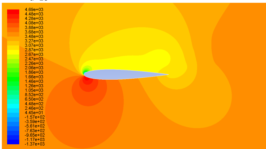
Σχήμα 5.9: Κατανομή ισοϋψών του πεδίου πίεσης γύρω από την αεροτομή για Re=3 \cdot 10^6 και γωνίες προσβολής \alpha=0^\circ, 2^\circ, 4^\circ, 6^\circ, 8^\circ, 10^\circ, 12^\circ, 14^\circ, 16^\circ, 17^\circ, 18^\circ . Οι μονάδες σε Pascal.
