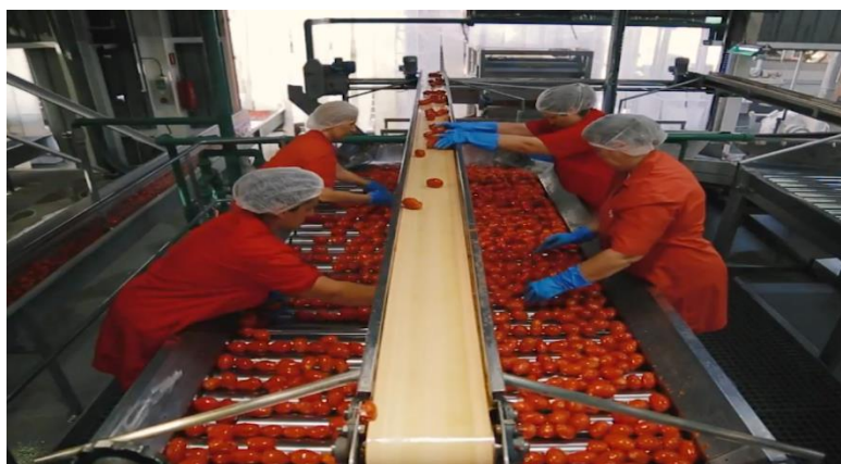
Εικόνα 4-7 : Τμήμα διαλογής τοματοπολτού-Τραπέζι διαλογής σκάρτης τομάτας 12
