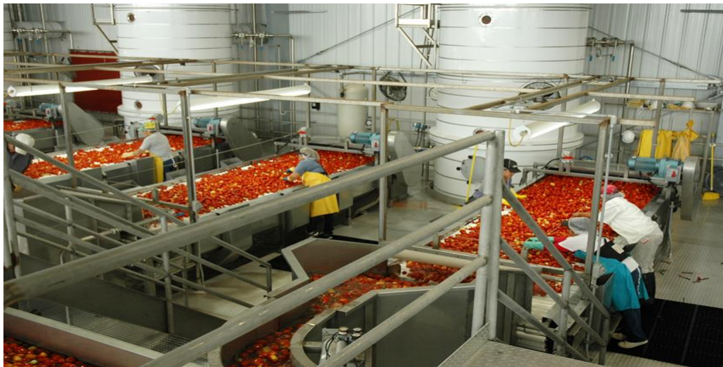
Εικόνα 4-4 : Τμήμα διαλογής αποφλοιωμένης- Τραπέζια διαλογής σκάρτης πρώτης ύλης 12
