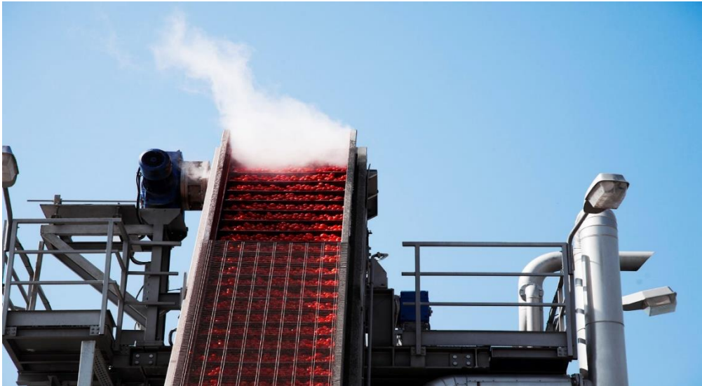
Εικόνα 4-5 : Μεταφορά της τομάτας στο θερμοδυναμικό αποφλοιωτή 12
