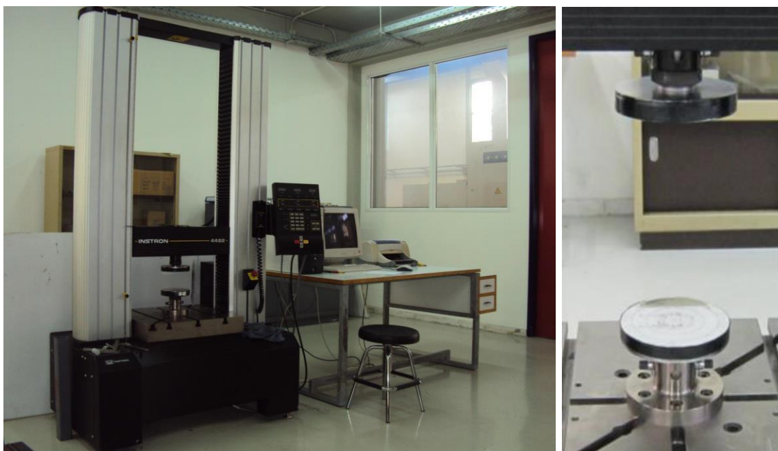
Εικόνα 4.7. Η πειραματική διάταξη που βρίσκεται στις εγκαταστάσεις του εργαστηρίου Κατεργασιών των Υλικών του ΕΜΠ (αριστερά). Τα εργαλεία θλίψης της INSTRON 4482 (δεξιά).
