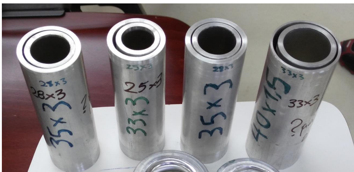
Εικόνα 4.3. Πρόχειρη απεικόνιση της διάταξης ζευγών (τα συγκεκριμένα ζεύγη της φωτογραφίας δεν χρησιμοποιήθηκαν στην παρούσα διπλωματική εργασία καθώς ξεπέρασαν το ονομαστικό φορτίο της μηχανής Instron και η διαδικασία σταμάτησε αρκετά γρήγορα. Η παραμόρφωση τους δεν είναι καθόλου ορατή).
