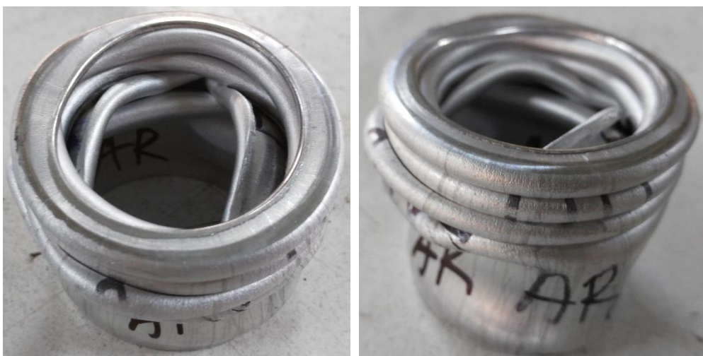
Εικόνα 4.2. Ρωγμές που δημιουργήθηκαν, χωρίς να υποβληθεί πρώτα σε ανόπτηση.
