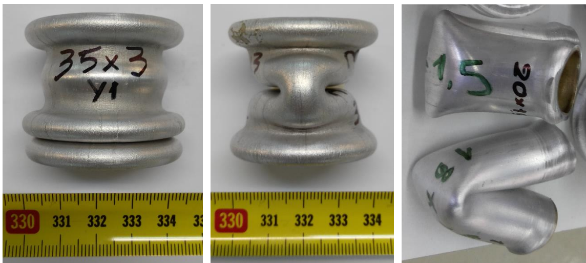
Εικόνα 3.2. Διάφοροι τρόποι κατάρρευσης. Αξονοσυμμετρικός (αριστερά), μικτός (μέση), λυγισμός τύπου Euler (δεξιά).
