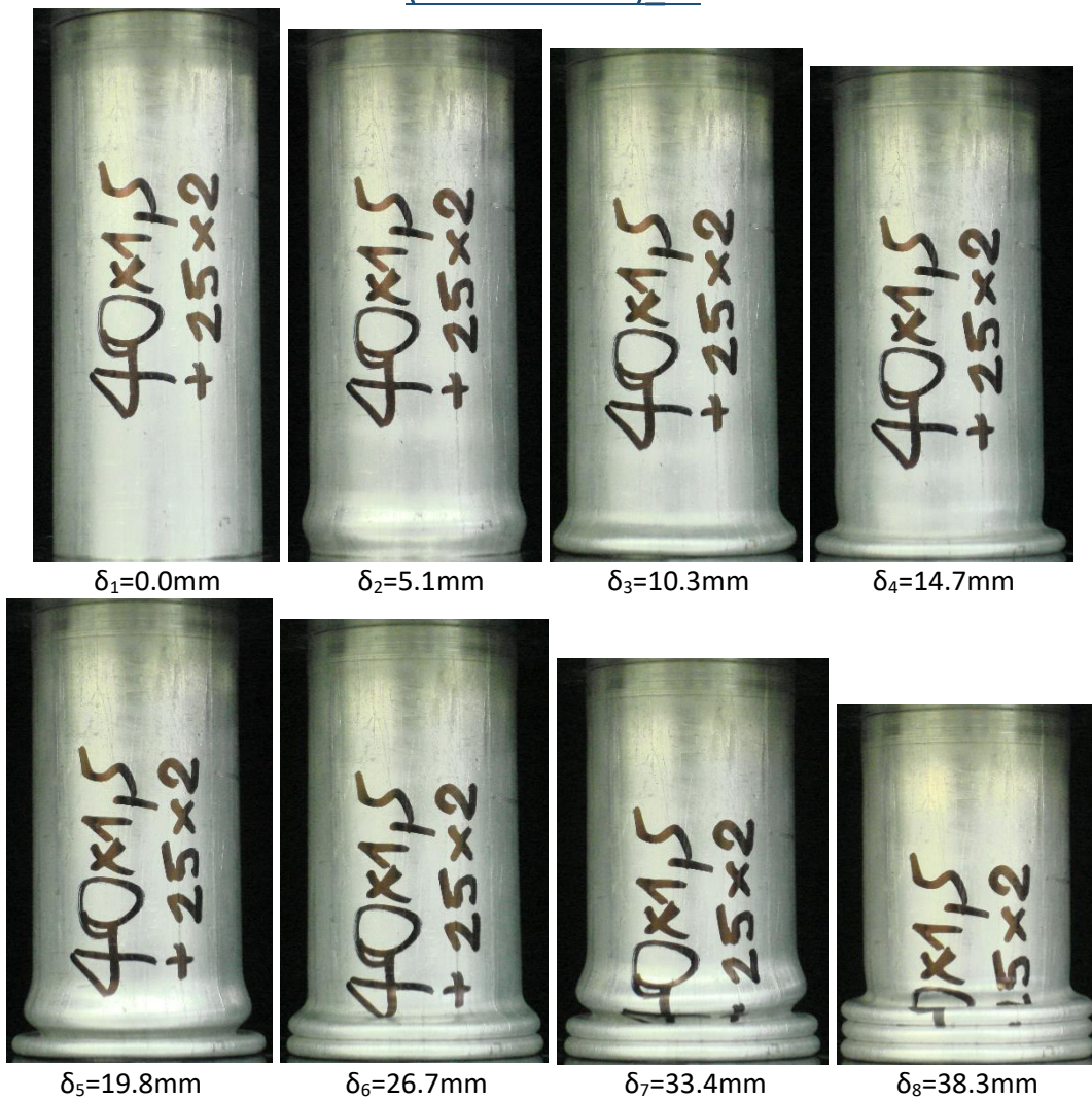
Εικόνα 5.14. Στιγμιότυπα κατάρρευσης (40x1.5 & 25x2)_Y2.
