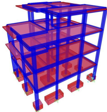
Εικόνα 3.1: Τρισδιάστατη(3D) απεικόνιση κτιρίου μέσω SAP
