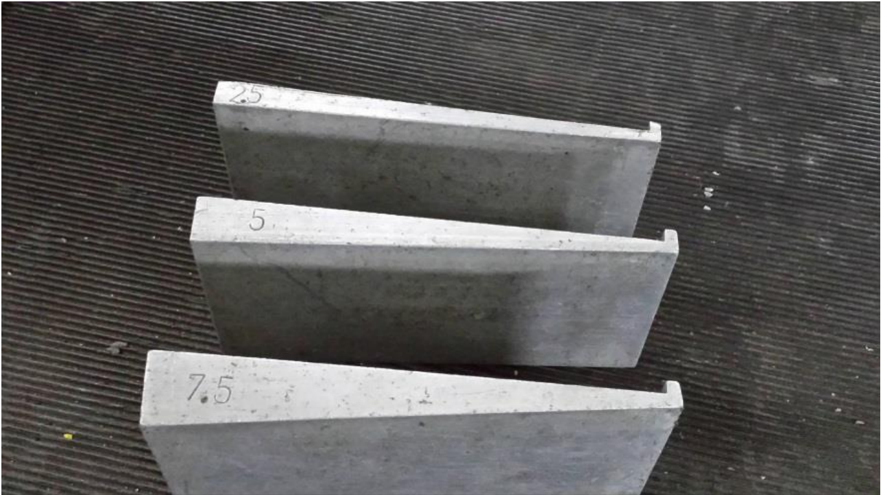
Εικόνα 10: Κλίμακα για τη βαθμονόμηση του Pitch.
