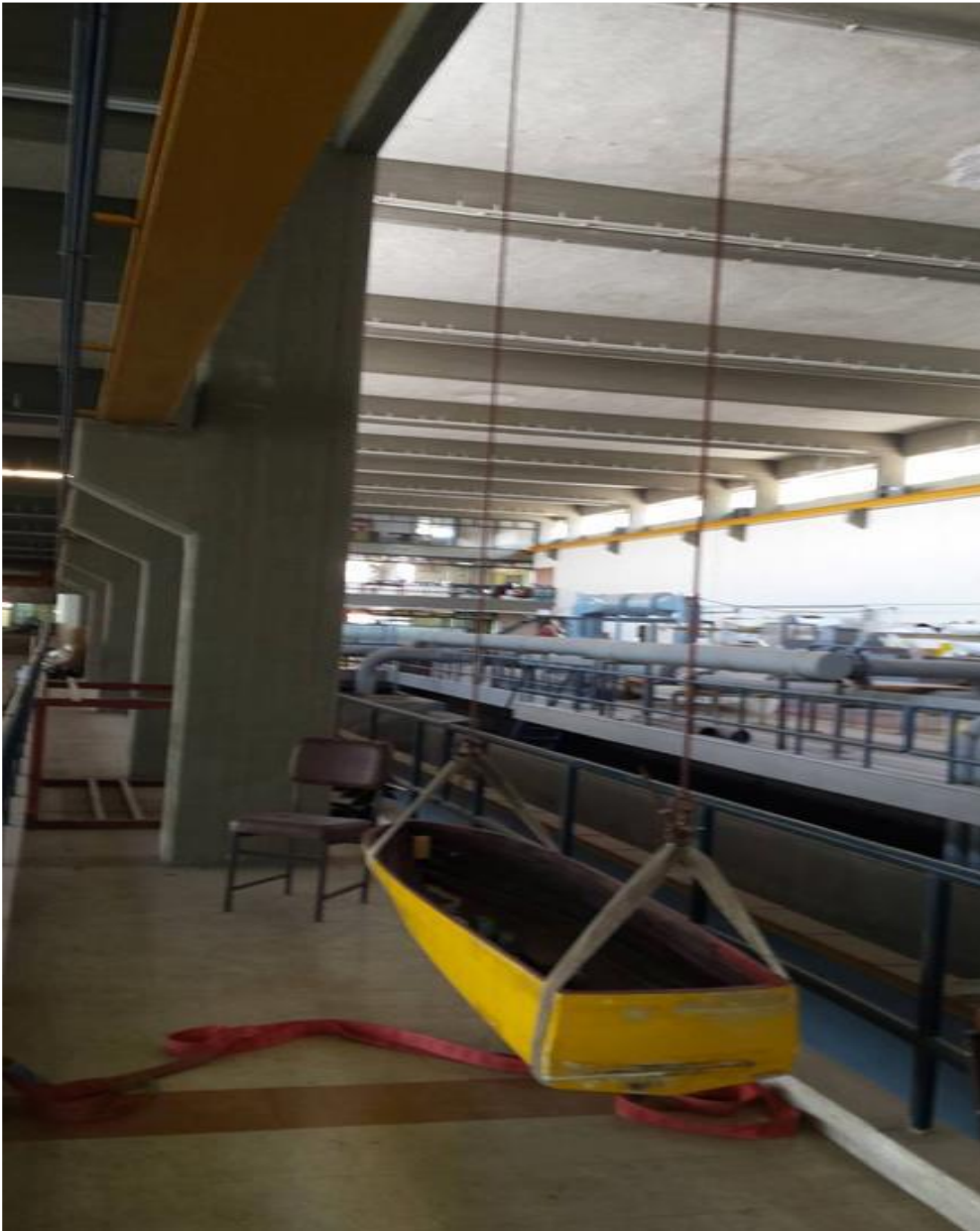
Εικόνα 5: Μοντέλο 113/95 δεμένο σε ιμάντες για την εύρεση της ακτίνας αδρανείας και περιόδου ιδιοταλάντωσης
