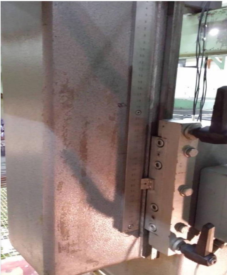
Εικόνα 9: Κλίμακα για τη βαθμονόμηση του Heave
