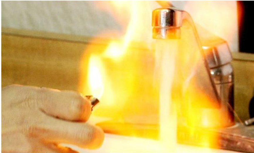
Εικόνα 5-5: Νερό βρύσης που αναφλέγεται λόγω των υψηλών συγκεντρώσεων μεθανίου που περιέχει (TheTelegraph, 2010).
