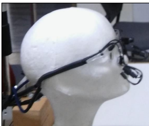
Εικόνα 2.14: Σύστημα πρόσδεσης στο οπτικό σύστημα του παρατηρητή, το οποίο φέρει πάνω του για κάθε οφθαλμό ξεχωριστά, μία κάμερα και μία φωτοδίοδο υπέρυθρης ακτινοβολίας
