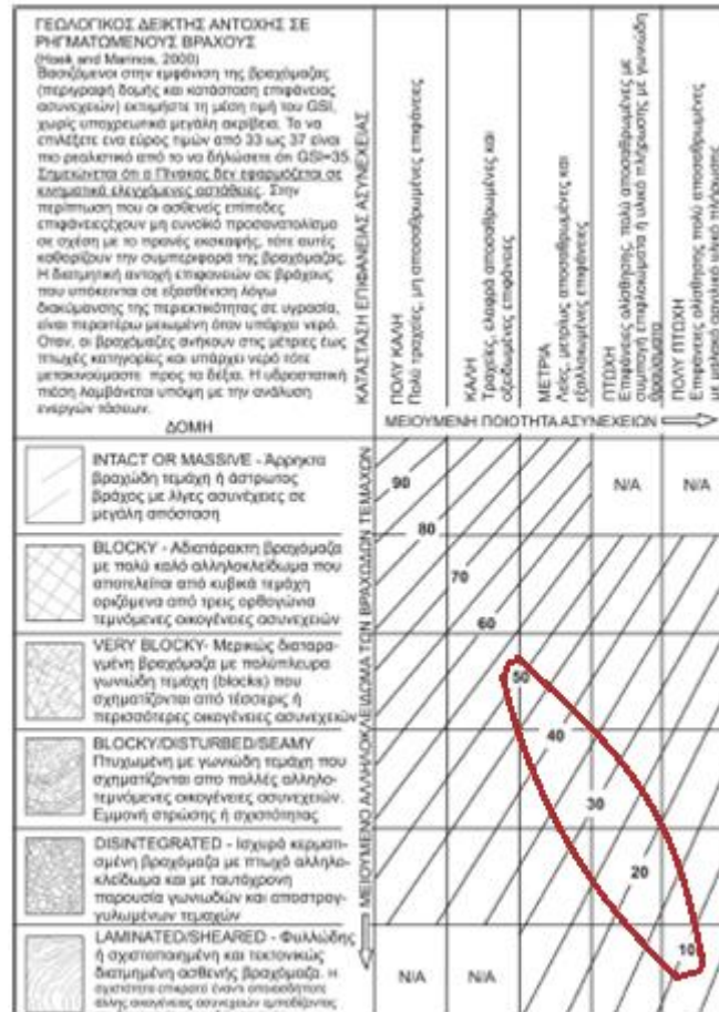
Σχήμα 3-10: Γεωλογικός Δείκτης Αντοχής GSI (Hoek&Marinos, 2000). Στην παρούσα έρευνα ο δείκτης κυμαίνεται από GSI=10 έως GSI=50
