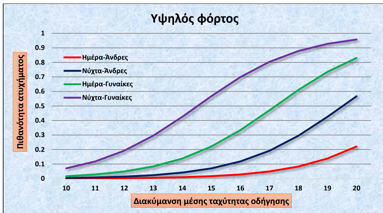
ΔΙΑΓΡΑΜΜΑ 5.26: Συσχέτιση της πιθανότητας ατυχήματος με τη διακύμανση της μέσης ταχύτητας οδήγησης για άνδρες και γυναίκες με υψηλό κυκλοφοριακό φόρτο κατά τη διάρκεια της ημέρας ή της νύχτας
