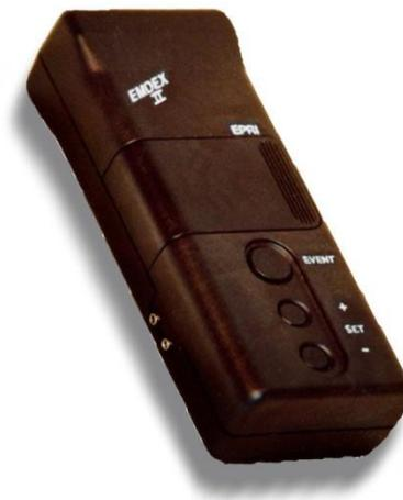
Το EMDEX II είναι ένα ισχυρό σύστημα μέτρησης μαγνητικού πεδίου το οποίο αποτελείται από ένα μικροϋπολογιστή 8-bit 512kb RAM βασισμένο στην πρότυπη EPRI συχνότητα ισχύος για την καταγραφή εκτιθέμενων μαγνητικών πεδίων. Το συγκεκριμένο μοντέλο έχει τη δυνατότητα μέτρησης πεδίων από 4mG έως 120G. Επίσης το συγκεκριμένο όργανο είναι σχεδιασμένο να μετρά μαγνητικά πεδία εναλλασσόμενου ρεύματος, συχνοτήτων 40 έως 800 Hz και μπορεί αυτόματα να απορρίπτει το μαγνητικό πεδίο της γης.
