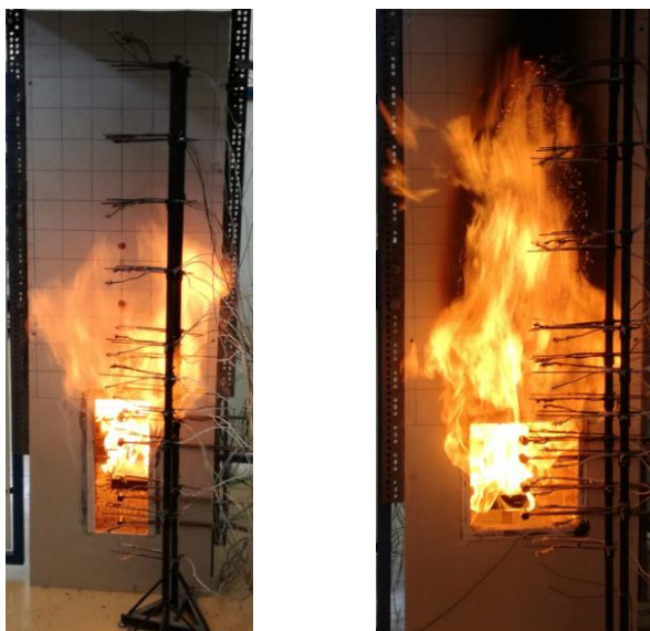
Σχήμα 5.2 Γεωμετρία ανοιγμάτων στην περίπτωση διάταξης πόρτας (αριστερά) και παραθύρου (δεξιά)
