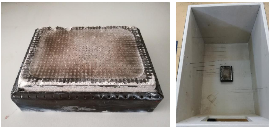
Σχήμα 4.5 Ο χρησιμοποιούμενος καυστήρας (αριστερά), τοποθετημένος εντός του διαμερίσματος (δεξιά), (φωτογραφία).
