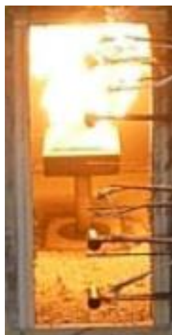
Σχήμα 5.1 Φωτογραφία των τοποθετημένων δικατευθυντικών μετρητών ταχύτητας στην περίπτωση της γεωμετρίας πόρτας (αριστερά) και παραθύρου (δεξιά), κατά τη διάρκεια πειράματος.
