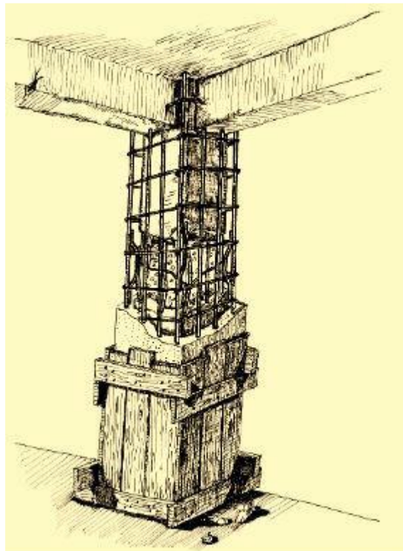
Σχήμα 6.1 Υποστήλωση και αποφόρτιση για κατασκευή μανδύα
