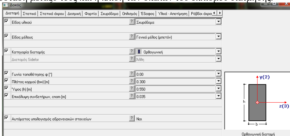
Σχήμα 3.9 Παράδειγμα ορισμού διατομής δοκού στο Fespa
