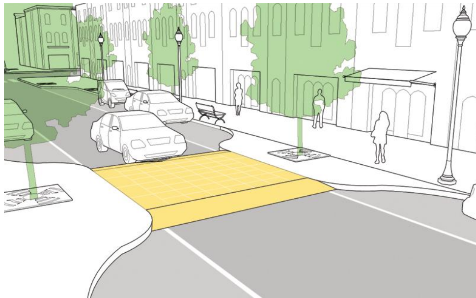
Εικόνα 4.35: Πλατώ μείωσης ταχύτητας (πηγή: https://nacto.org/publication/urban-street-design-guide/street-design-elements/ )
