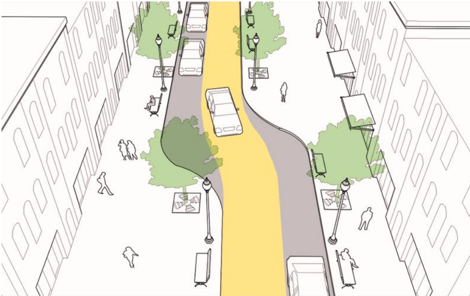
Εικόνα 4.36: Άξονας σχήματος «S» (πηγή: https://nacto.org/publication/urban-street-design-guide/street-design-elements/ )
