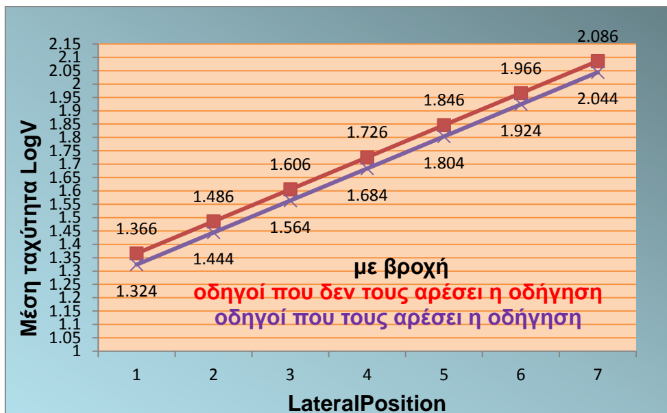
Διάγραμμα 5.11: Συσχέτιση της μέσης ταχύτητας του οχήματος με την απόσταση του οχήματος από την δεξιά οριογραμμή του οδοστρώματος, σε διαδρομές με βροχή, για οδηγούς που τους αρέσει η οδήγηση και οδηγούς που δεν τους αρέσει η οδήγηση.
