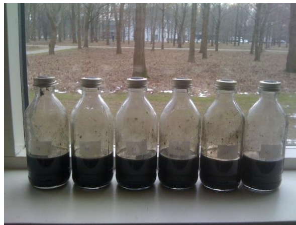
Εικόνα 24 Αντιδραστήρες που περιέχουν ΧΚΧ ως πηγή βιομάζας και Ulva lactuca ως πηγή οργανικού άνθρακα.
