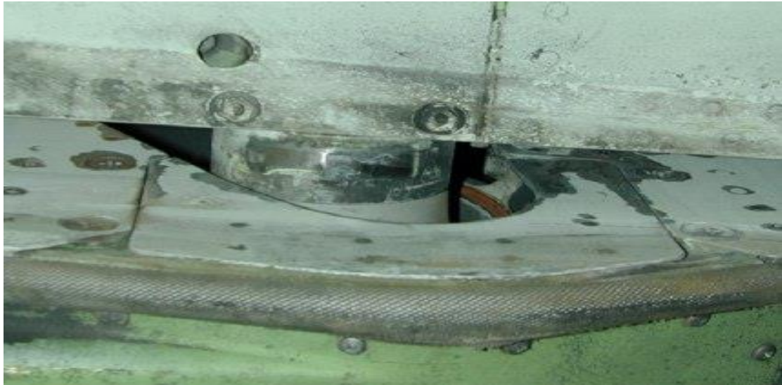
Εικόνα 1.7 μηχανική διάβρωση εκ τριβής δύο εξαιρετικά φορτισμένων επιφανειών οι οποίες δεν σχεδιάστηκαν ώστε να κινούνται μεταξύ τους.
