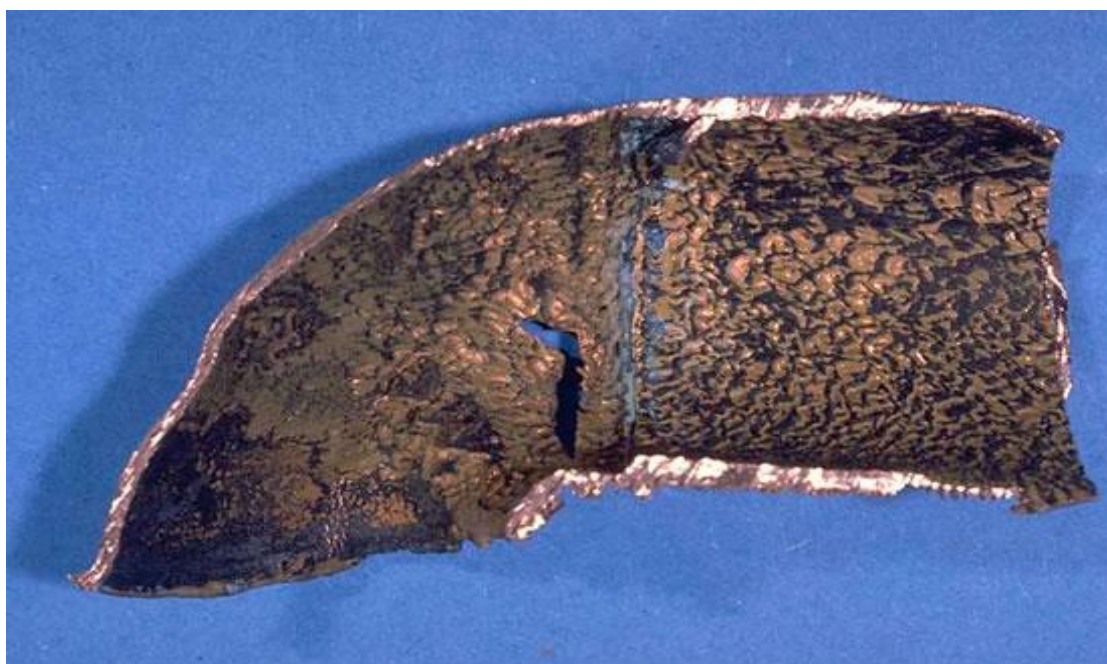
Εικόνα 1.14 πεταλοειδής μορφή εργοδιάβρωσης χαλκοσωλήνα
