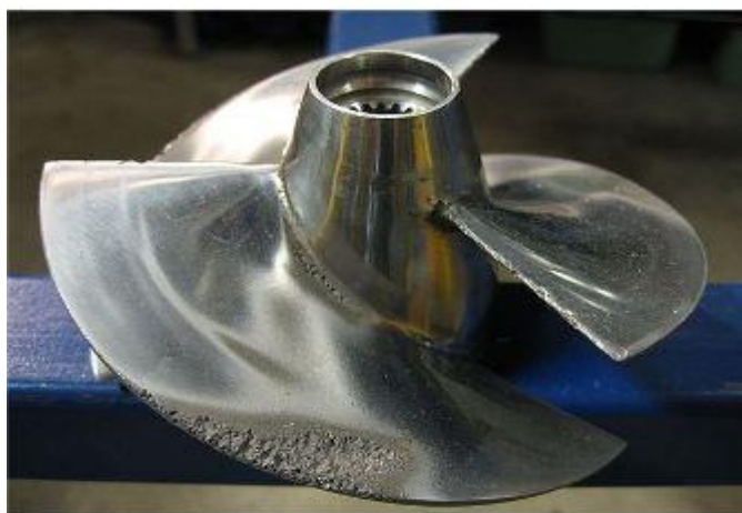
Εικόνα 1.17 σπηλαιώδης μηχανική διάβρωση προπέλας
