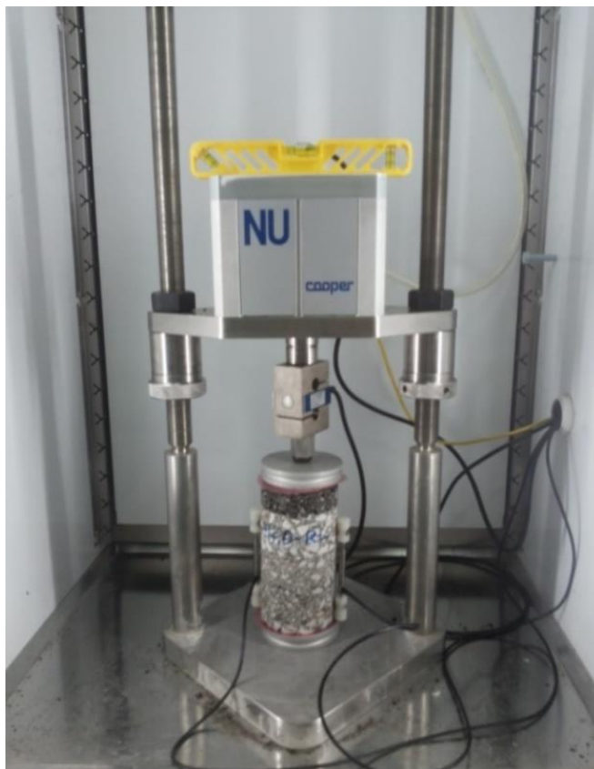
Εικόνα 4.6 Διάταξη δοκιμής προσδιορισμού του E^*
