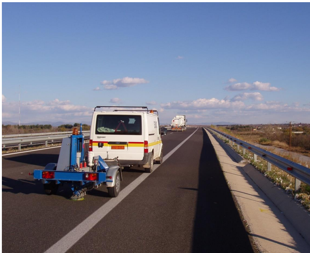
Εικόνα 2.12 Σύστημα καταγραφής FWD του ΕΜΠ
