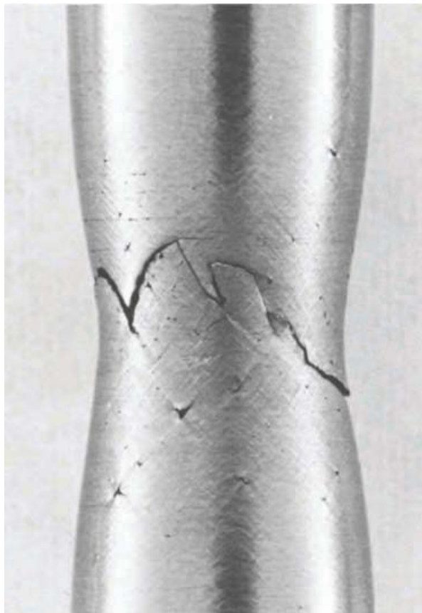
Σχ.2.10 Δοκίμιο χυτού χάλυβα χαμηλού σε άνθρακα με έμφαση στον 45ο διαμητικό προσανατολισμό της όλκιμης θραύσης ενός όλκιμου μετάλλου. Οι διαγώνιες κορυφογραμμές είναι οι "Γραμμές Luders" ή "Στελέχη φορείου". Το πορώδες στον χάλυβα παρουσιάζει πολλά εντοπισμένα κατάγματα.
