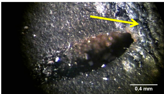
Σχ.4.72 Επικαθήσεις και φουσκώματα (dimples) στα πτερύγια
