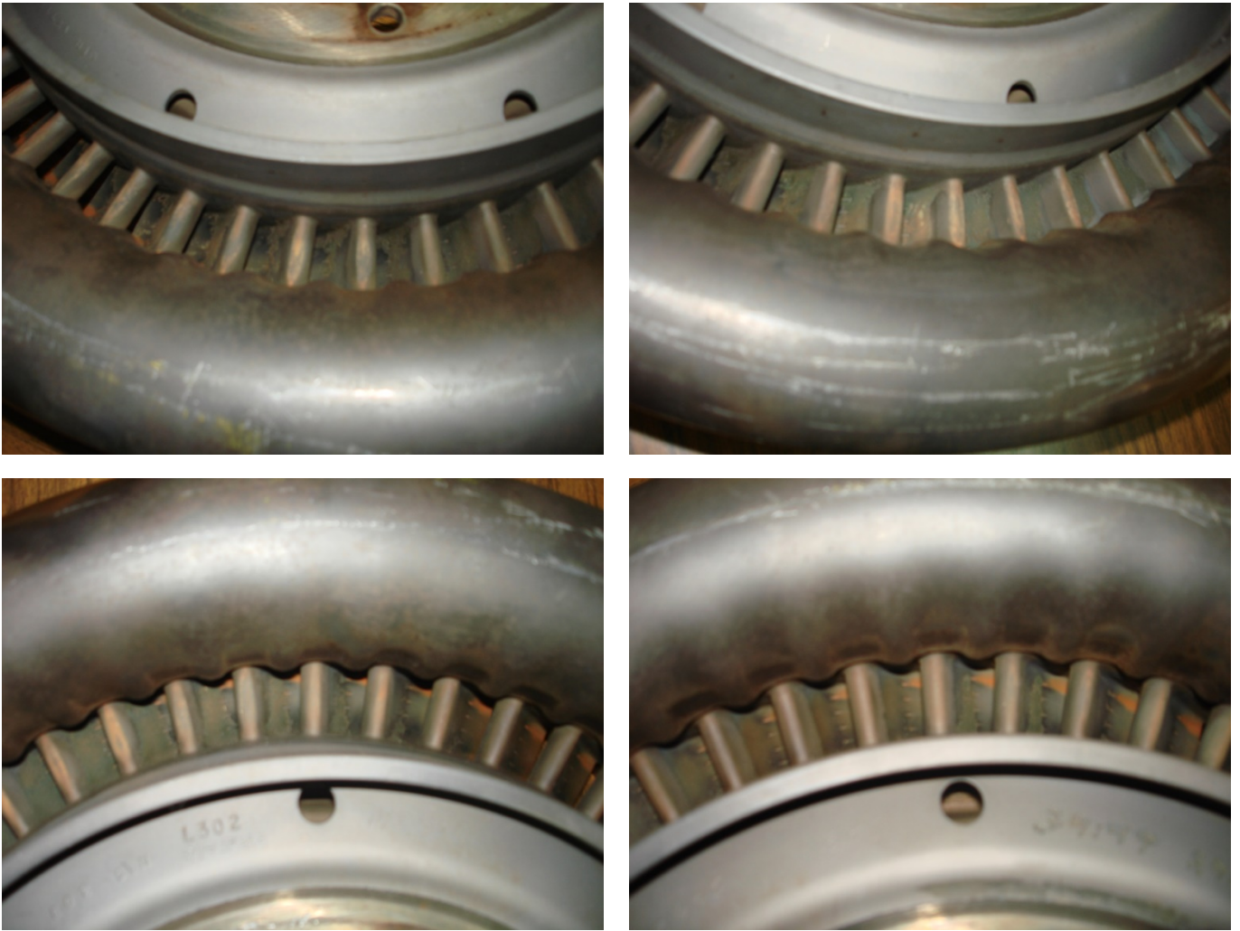
Σχ.4.13 Οξείδωση, αποχρωματισμός και επικαθήσεις στην εμπρόσθια μεριά των πτερυγίων.
