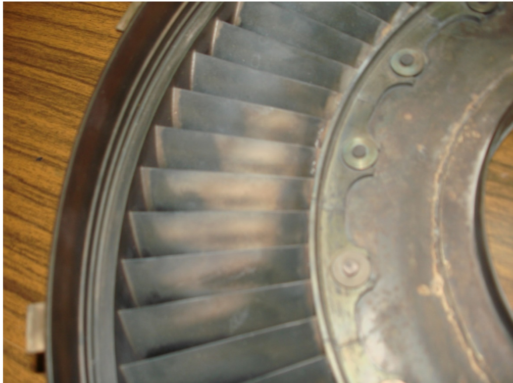
Σχ.4.80 Εμφανής επιφανειακή οξείδωση.
