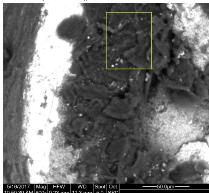
Σχ.4.58 Ανάλυση στην σκούρα περιοχή της μύτης της ρωγμής .
