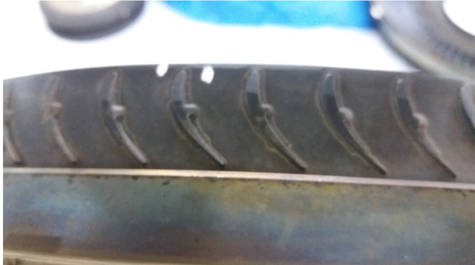
Σχ.4.79 Συγκολλήσεις που αστόχησαν κατά την δοκιμή προγραμματισμένης επιθεώρησης.
