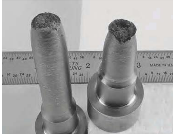
Σχ.2.9 Ένα θραυσμένο δοκίμιο εφελκυσμού με το τυπικό σχήμα θραύσης (cup and cone) των όλκιμων μετάλλων που θραύονται σε τάση.
