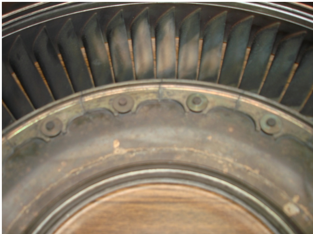
Σχ.4.82 Εμφανής επιφανειακή οξείδωση.
