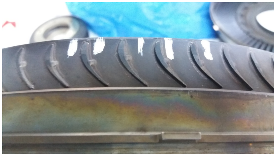
Σχ.4.78 Συγκολλήσεις που αστόχησαν κατά την δοκιμή προγραμματισμένης επιθεώρησης.
