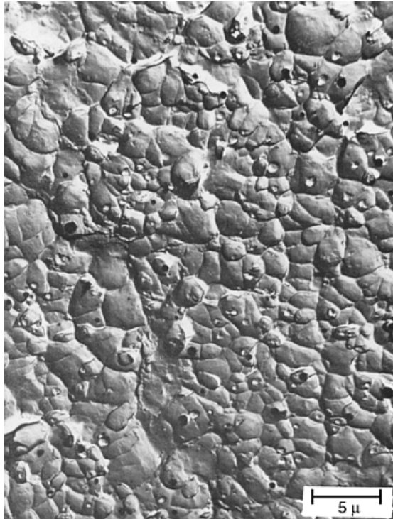
Σχ.2.38 Μπιμπικωτή θραύση (Dimple fracture) που δημιουργήθηκε από συνένωση μικροκενών σε βαμμένο και σκληρυμένο χάλυβα. Να σημειωθεί η παρουσία σωματιδίων καρβιδίων στον πάτο πολλών μπιμπικιών. [5]
