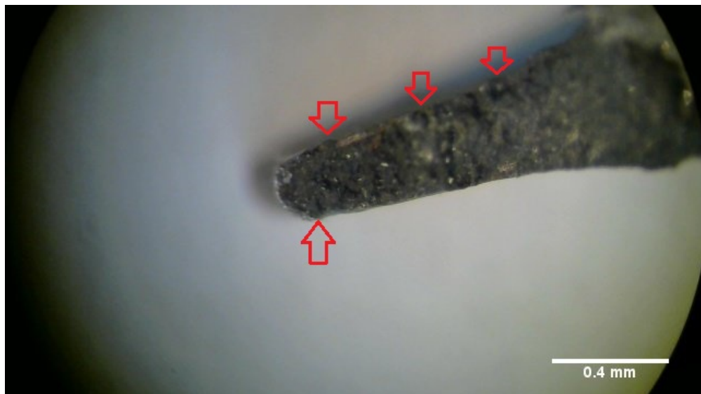
Σχ.4.55 Εικόνα μεγέθυνσης ρωγμής πτερυγίου (2x) με εμφανείς επικαθήσεις.
