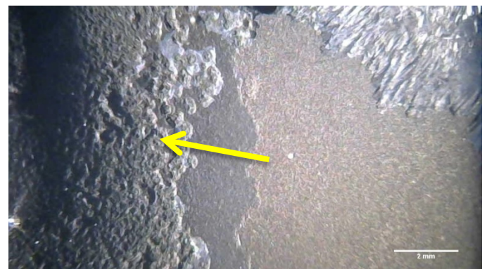
Σχ.4.72 Επικαθήσεις και φουσκώματα (dimples) στα πτερύγια
