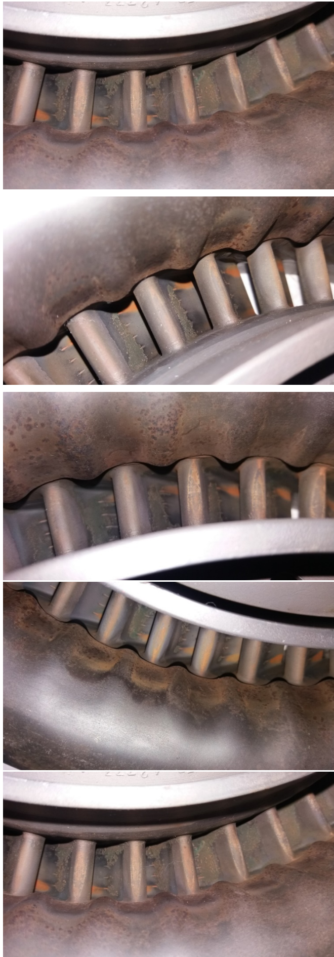
Σχ.4.15 Οξείδωση, αποχρωματισμός, απώλεια επικάλυψης και επικαθήσεις στην εμπρόσθια μεριά των πτερυγίων (χείλος προσβολής).
