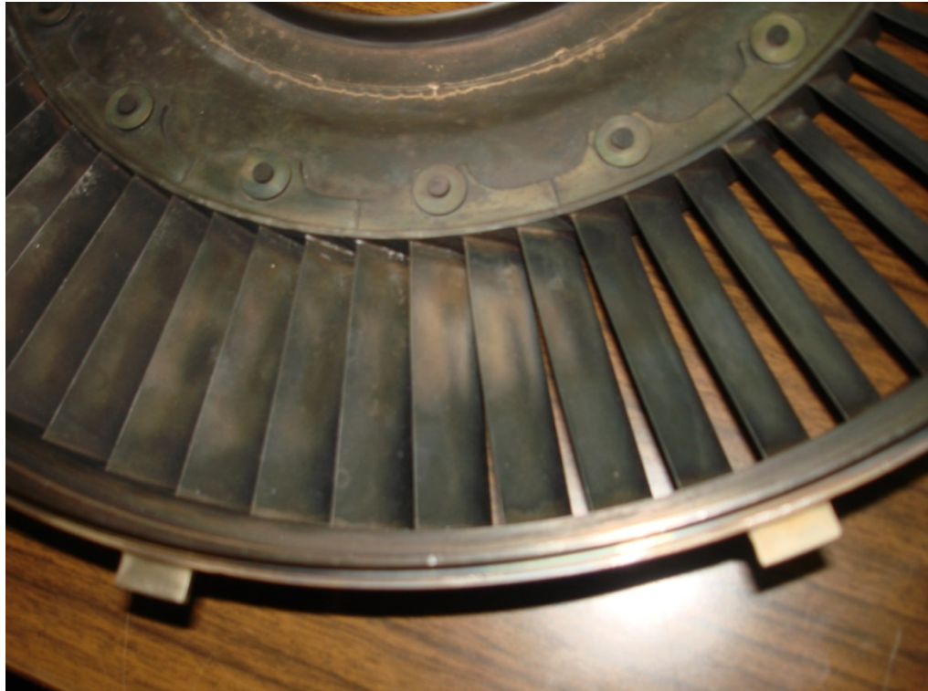
Σχ.4.81 Εμφανής επιφανειακή οξείδωση.
