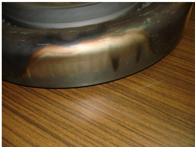
Σχ.4.12 Αποχρωματισμός στην εξωτερική μεριά του κομματιού.
