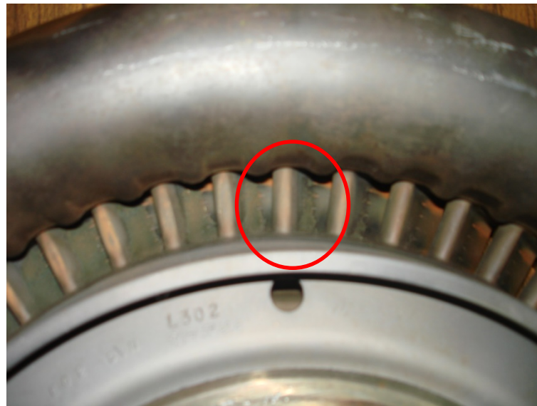
Σχ.4.71 Εμφανής φθορά στο χείλος προσβολής.
