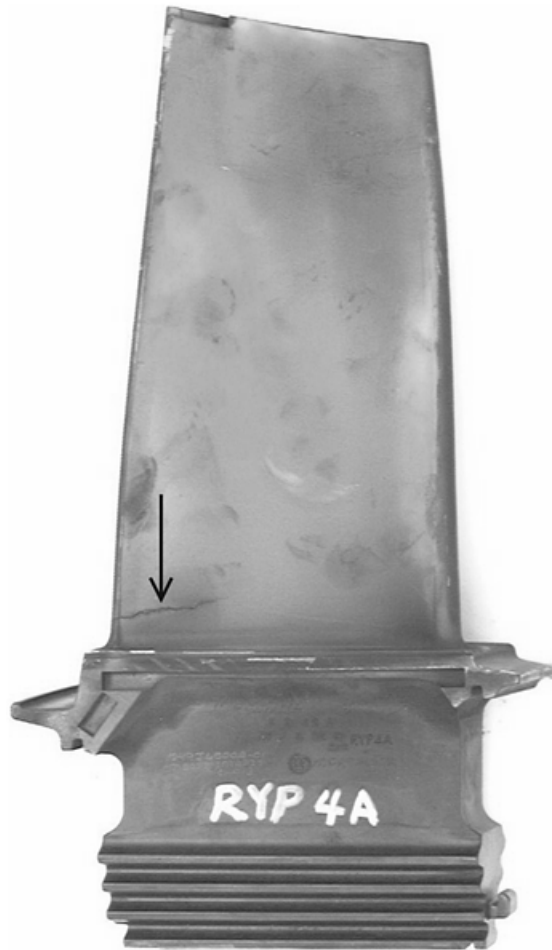
Σχ.2.34 Ρωγμή (βέλος) που παρατηρείται στο χείλος εκφυγής κοντά στη βάση πτερυγίου τουρμπίνας που λειτούργησε σχεδόν μέχρι τον μέγιστο προβλεπόμενο χρόνο. [5]
