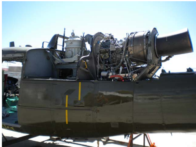
Σχ.4.8 Ο κινητήρας χωρίς το κάλυμμα πάνω στο ελικόπτερο.
