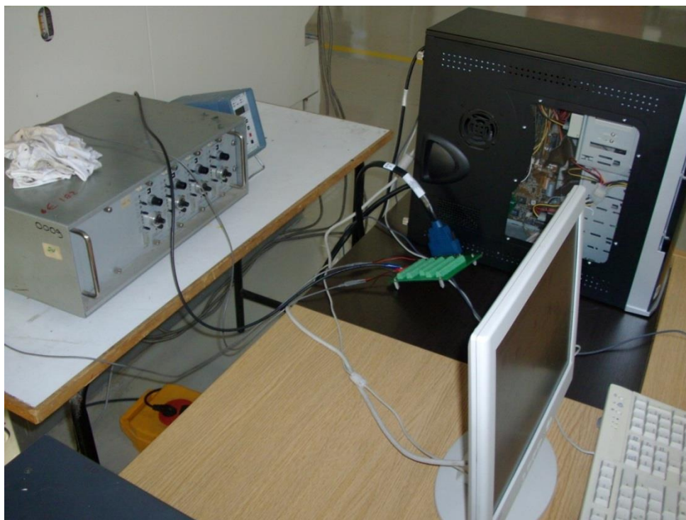
ΣΧΗΜΑ 5.3 Σύνδεση των δύο ενισχυτών με την μετρητική κάρτα και με τον Η/Υ
