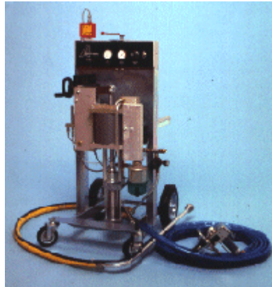
Εικόνα 21 – Μηχανή ψεκασμού ρητίνης & ινών
