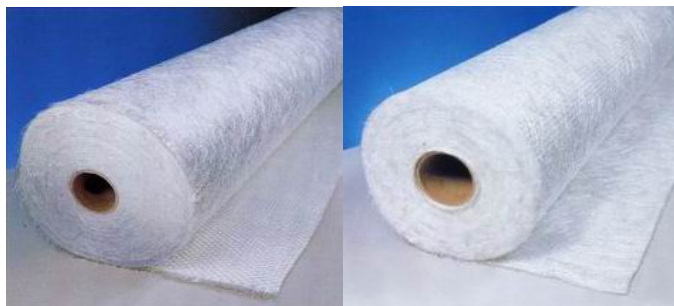
Εικόνα 25 – Ρολά υφασμάτων ενισχυτικών ινών
