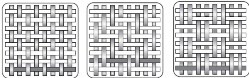
Εικόνα 6α & 6β – Τύπος διάταξης ινών και εμπορικός τύπος Υαλουφάσματος
