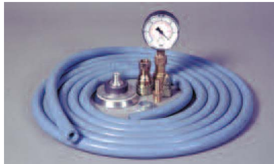
Εικόνα 34 – Αντλία αναρρόφησης αέρα & ελέγχου πίεσεως
