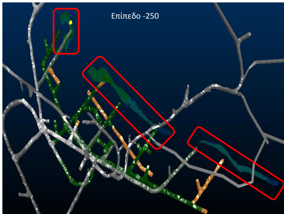
Σχήμα 5.4.: Γεωμετρία του κοιτάσματος στο επίπεδο -250
