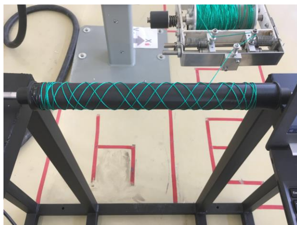
Εικόνα 8-10 Κυλινδρικό καλούπι, 70 μοίρες, ενδιάμεση φάση
