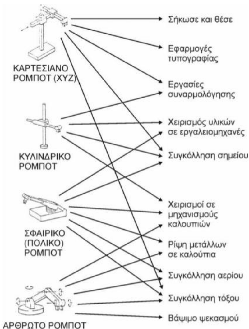
Εικόνα 1-7 Χρήση των καρτεσιανών, κυλινδρικών, σφαιρικών και αρθρωτών ρομπότ στις διάφορες βιομηχανικές εφαρμογές
