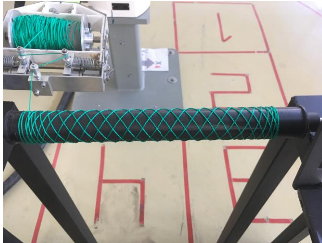
Εικόνα 8-11 Κυλινδρικό καλούπι, 70 μοίρες, τελικό αποτέλεσμα
