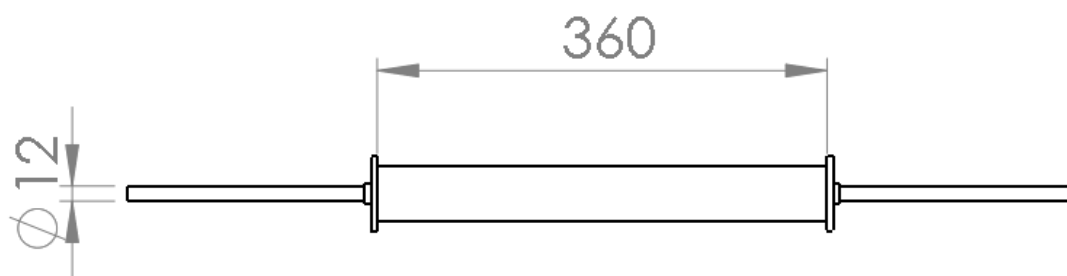
Εικόνα 7-3 Μηχανολογικό σχέδιο κυλινδρικού καλουπιού
