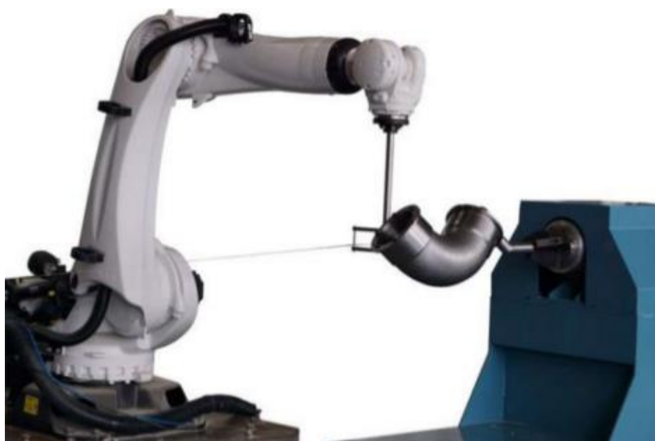
Εικόνα 3-10 ρομποτικό σύστημα περιέλιξης ιών [18]
