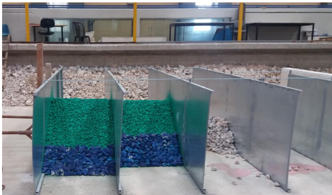
Εικόνα 5.5: Κατασκευή πυρήνα, υπόστρωσης και πρώτης στρώσης θωράκισης των Μοντέλων 1 και 2
