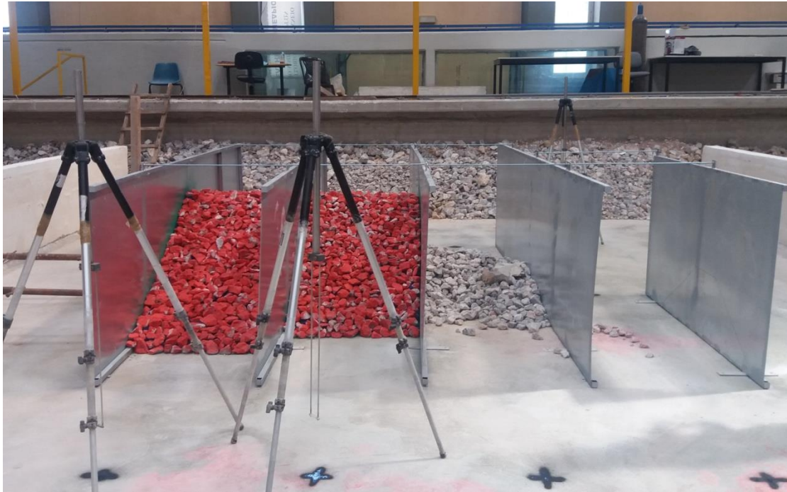
Εικόνα 5.6: Κατασκευή δεύτερης στρώσης θωράκισης των Μοντέλων 1 και 2
