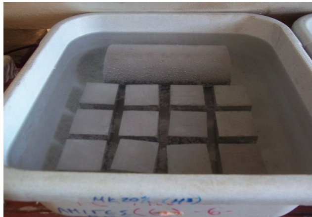
Εικόνα 6 : Συντήρηση σε νερό 12 κυβικών κι ενός κυλινδρικού δοκιμίου, σύνθεσης MK20
