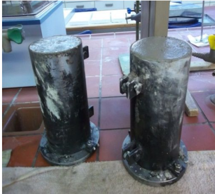
Εικόνα 5 : Παρασκευή δοκιμίων. Στα αριστερα, κυλινδρικά δοκίμια 200x100 (mm), στα δεξιά, κυβικά δοκίμια 50x50 (mm)
