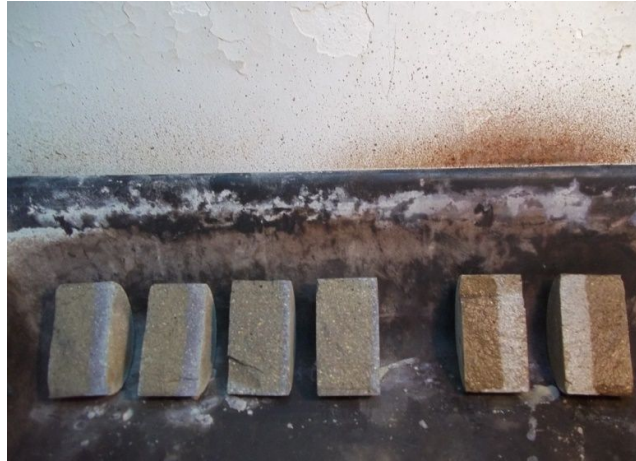
Εικόνα 18 : Δοκίμια μετά από διάρρηξη και ψεκασμό με \text{AgNO}_3 . Αριστερά, η Σύνθεση MSF10, στη μέση, η MSF20, δεξιά η GBF10.
