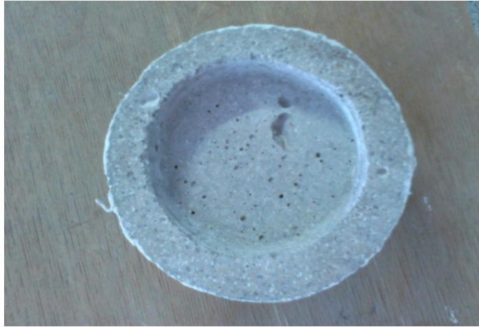
Εικόνα 21 : Δοκίμιο μετά τη λήψη δειγμάτων σκόνης σε όλα τα βάθη (0-16 mm)
