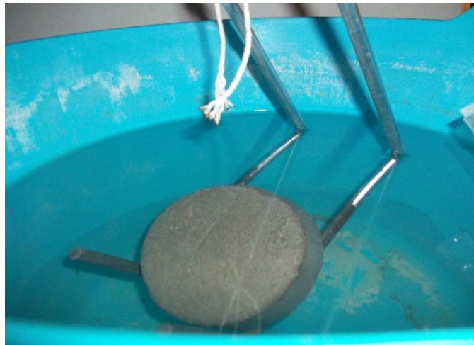
Εικόνα 11 : Μέτρηση μάζας υπό άνωση ( M_{imm} )
