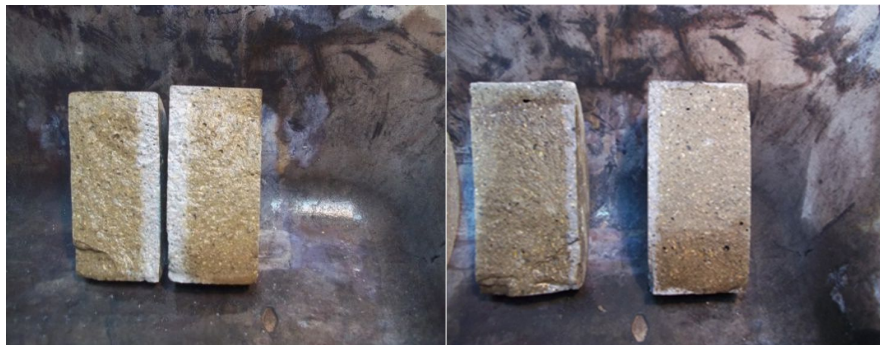
Εικόνα 19 : Δοκίμια μετά από ψεκασμό με \text{AgNO}_3 . Αριστερά, η σύνθεση MK10, δεξιά, η σύνθεση MK20.
