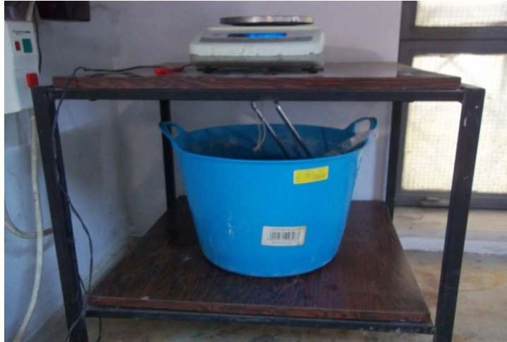
Εικόνα 10 : Διαδικασία μέτρησης ανοικτού πορώδους: μέτρηση μάζας υπό άνωση ( M_{imm} )
