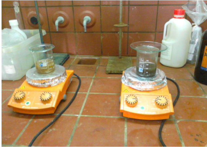
Εικόνα 24 : Μαγνητικός αναδευτήρας για τη θέρμανση κι ανάδευση διαλύματος σκόνης
