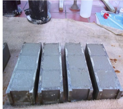
Εικόνα 5 : Παρασκευή δοκιμίων. Στα αριστερα, κυλινδρικά δοκίμια 200x100 (mm), στα δεξιά, κυβικά δοκίμια 50x50 (mm)
