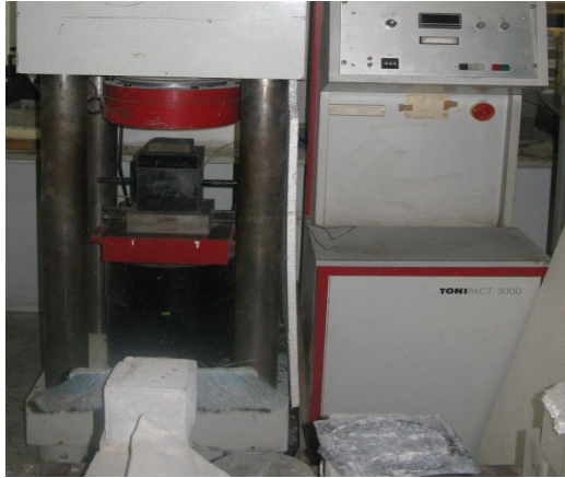
Εικόνα 8 : Διάταξη δοκιμής σε μονοαξονική θλίψη για τη μέτρηση της θλιπτικής αντοχής f_c
