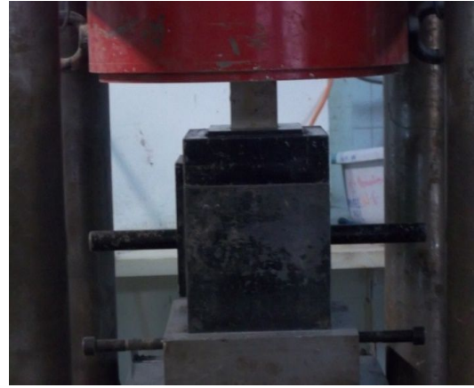
Εικόνα 8 : Διάταξη δοκιμής σε μονοαξονική θλίψη για τη μέτρηση της θλιπτικής αντοχής f_c
