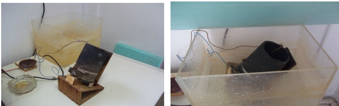
Εικόνα 16: Αριστερα, η πειραματική διάταξη της δοκιμής NT492, δεξιά, η διάταξη με το ηλεκτρικό κύκλωμα σε λειτουργία
