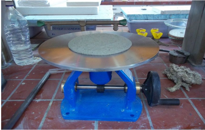
Εικόνα 7: Διάταξη δοκιμής κάθισης (mini slump test) σύμφωνα με το πρότυπο EN 1015
