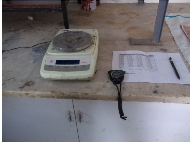
Εικόνα 12 : Διεξαγωγή πειράματος τριχοειδούς απορρόφησης
