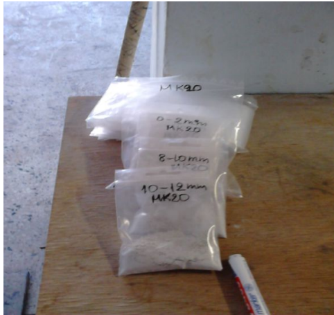
Εικόνα 22 : Δείγματα σκόνης της Σύνθεσης MK20 σε βάθη από 2 έως 16 mm
