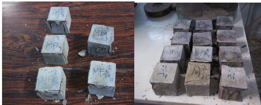
Εικόνα 9 : Θραύση δοκιμίων μετά από μονοαξονική θλίψη
