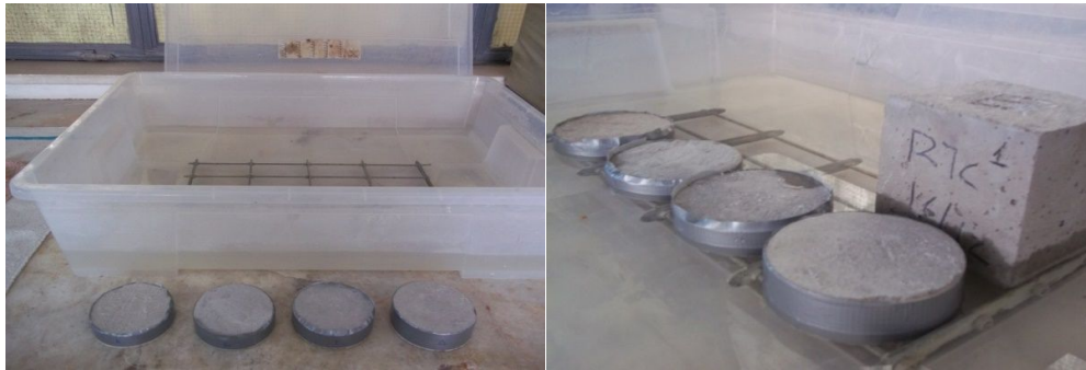
Εικόνα 13 : Στα αριστερά, προετοιμασία δοκιμίων για το πείραμα τριχοειδούς απορρόφησης, δεξιά, διεξαγωγή πειράματος
