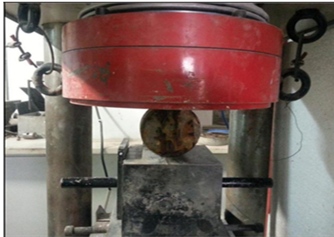
Εικόνα 17 : Διάρρηξη δοκιμίου για τον προσδιορισμό της διείσδυσης των Cl^-
