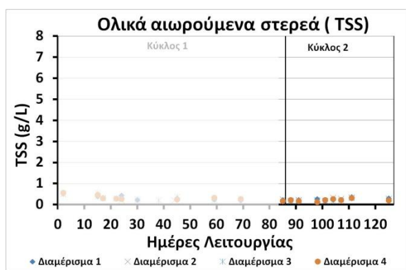
Σχήμα 7.4.16 Συγκέντρωση ολικών αιωρούμενων στερεών στο εσωτερικό των 4 διαμερισμάτων του PABR κατά τη διάρκεια του δεύτερου πειραματικού κύκλου
