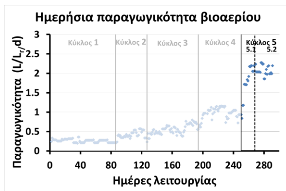
Σχήμα 7.4.75 Ημερήσια παραγωγικότητα βιοαερίου κατά τη διάρκεια του πέμπτου κύκλου
