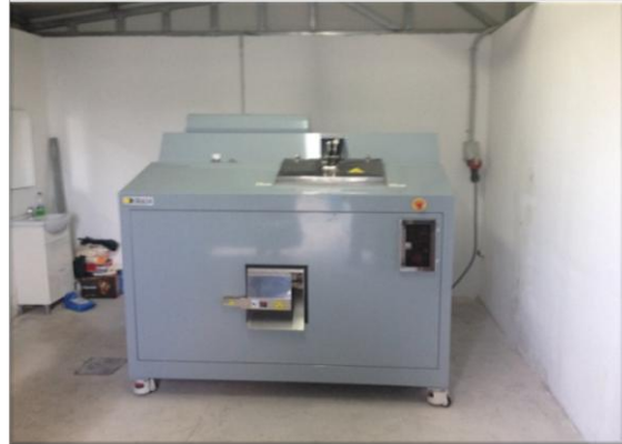
Εικόνα 7.2.5 Ο ξηραντήρας στο οποίο πραγματοποιείται η επεξεργασία των συλλεχθέντων απορριμμάτων
