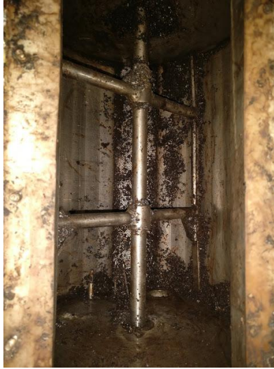
Εικόνα 5.2.7 Η διάτρητη μεταλλική επιφάνεια στο κάτω μέρος του αντιδραστήρα και το σύστημα ανάδευσης
