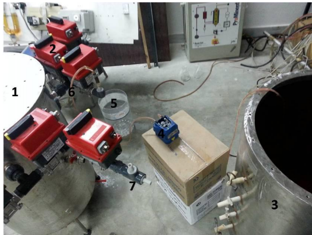
Εικόνα 4.1.1 Πειραματική διάταξη πιλοτικού PABR όπου φαίνονται: 1. ο αντιδραστήρας, 2. οι συστοιχίες των ηλεκτροβανών, 3. το δοχείο τροφοδοσίας, 4. η δοσομετρική αντλία, 5. το δοχείο συλλογής της εκροής, 6. ο σωλήνας τροφοδοσίας και 7. η εκροή του αντιδραστήρα
