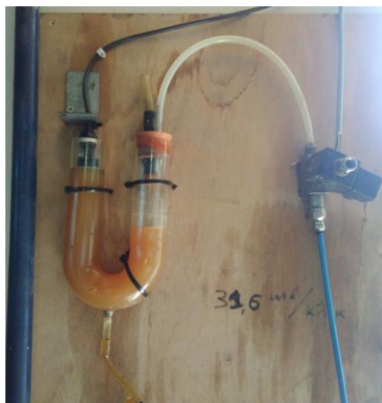
Εικόνα 5.1.1 Η διάταξη μέτρησης του παραγόμενου βιοαερίου (κλικογράφος)
