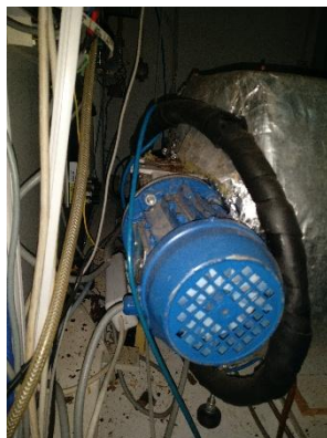
Εικόνα 5.2.5 Το μοτέρ της μηχανικής ανάδευσης στο πίσω μέρος του αντιδραστήρα
