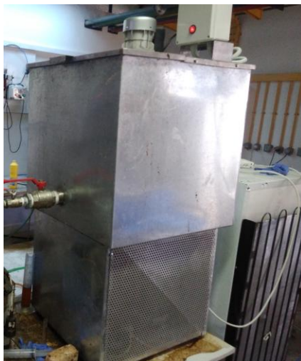
Εικόνα 5.2.3 Το ψυγείο διατήρησης και ανάδευσης της τροφοδοσίας
