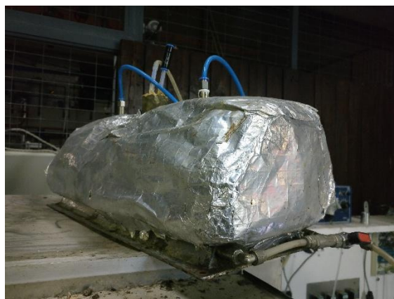
Εικόνα 5.2.6 Το ειδικά σχεδιασμένο καπάκι του αντιδραστήρα
