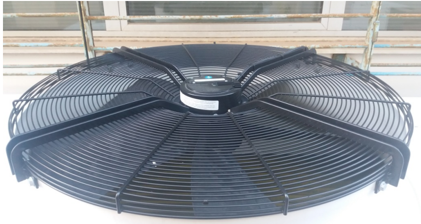
Εικόνα 6.6: Recooler του συστήματος ηλιακής ψύξης
