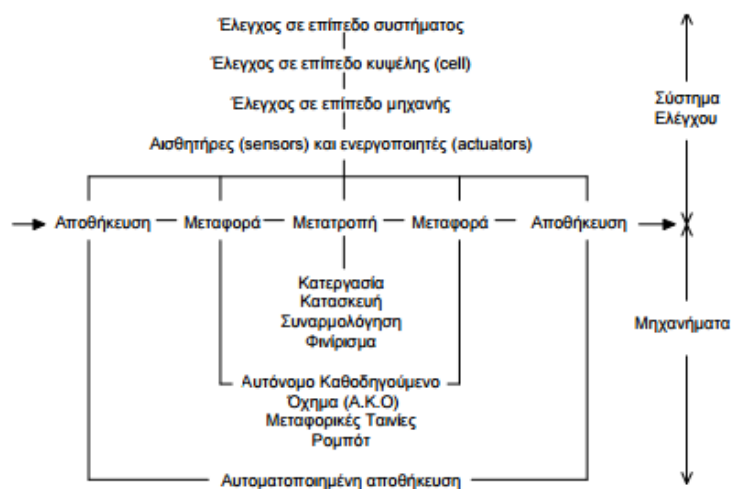
Εικόνα 7: Εποπτική λειτουργία ενός ευέλικτου συστήματος κατεργασίας
