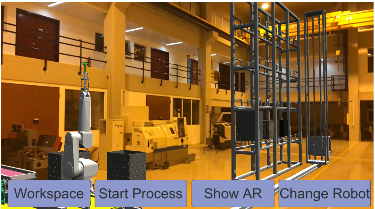
Εικόνα 49: Σύστημα Αυτόματης Αποθήκευσης και Ανάκτησης (ASRS) στο Εργαστήριο Τεχνολογίας των Κατεργασιών
