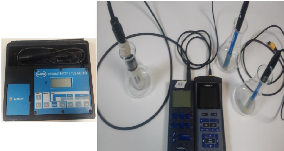
Σχήμα 17 Φορητή συσκευή μέτρησης της ηλ. Αγωγιμότητας (αριστερά), φορητό οξυγονόμετρο (κέντρο) και πολύμετρο μέτρησης pH, T και ORP (δεξιά)
