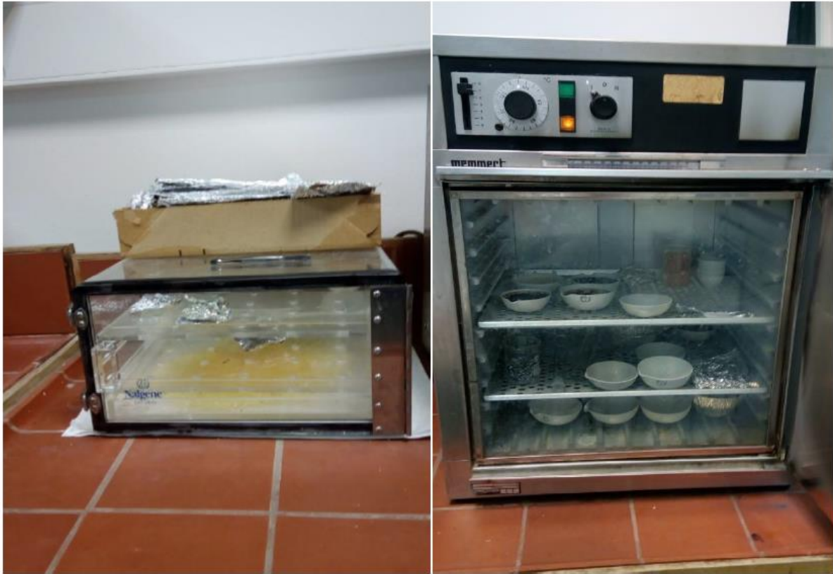
Σχήμα 12 Αφυγραντήρας και φούρνος θερμοκρασίας 105 °C για τον προσδιορισμό των TSS
