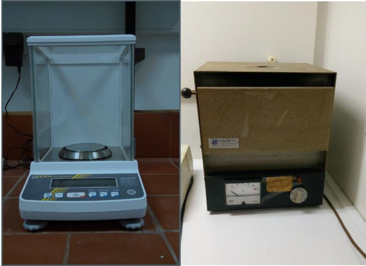
Σχήμα 13 Ζυγός ακριβείας και κλίβανος θερμοκρασίας 550 °C για τον προσδιορισμό των VSS
