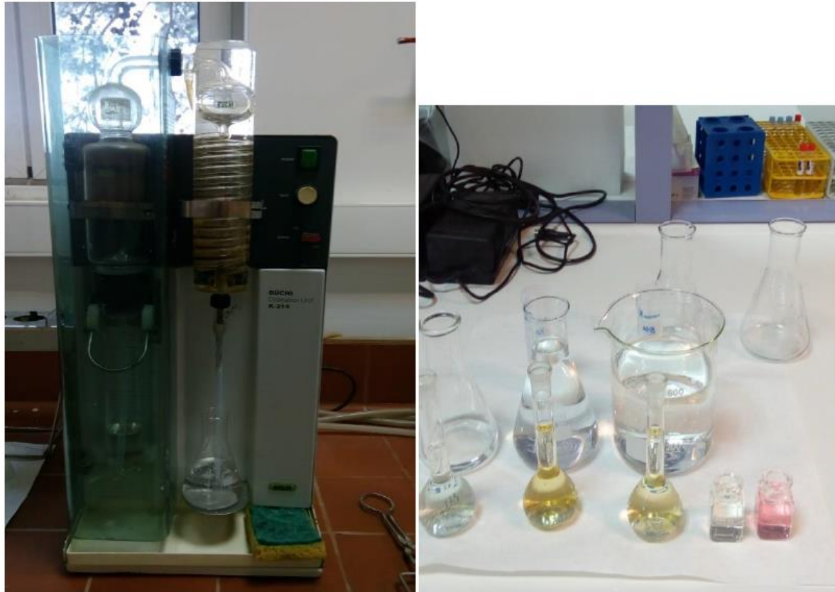
Σχήμα 15 Συσκευή απόσταξης BUCHI K-314 και προετοιμασία δειγμάτων για τον προσδιορισμό του αμμωνιακού και νιτρώδους αζώτου
