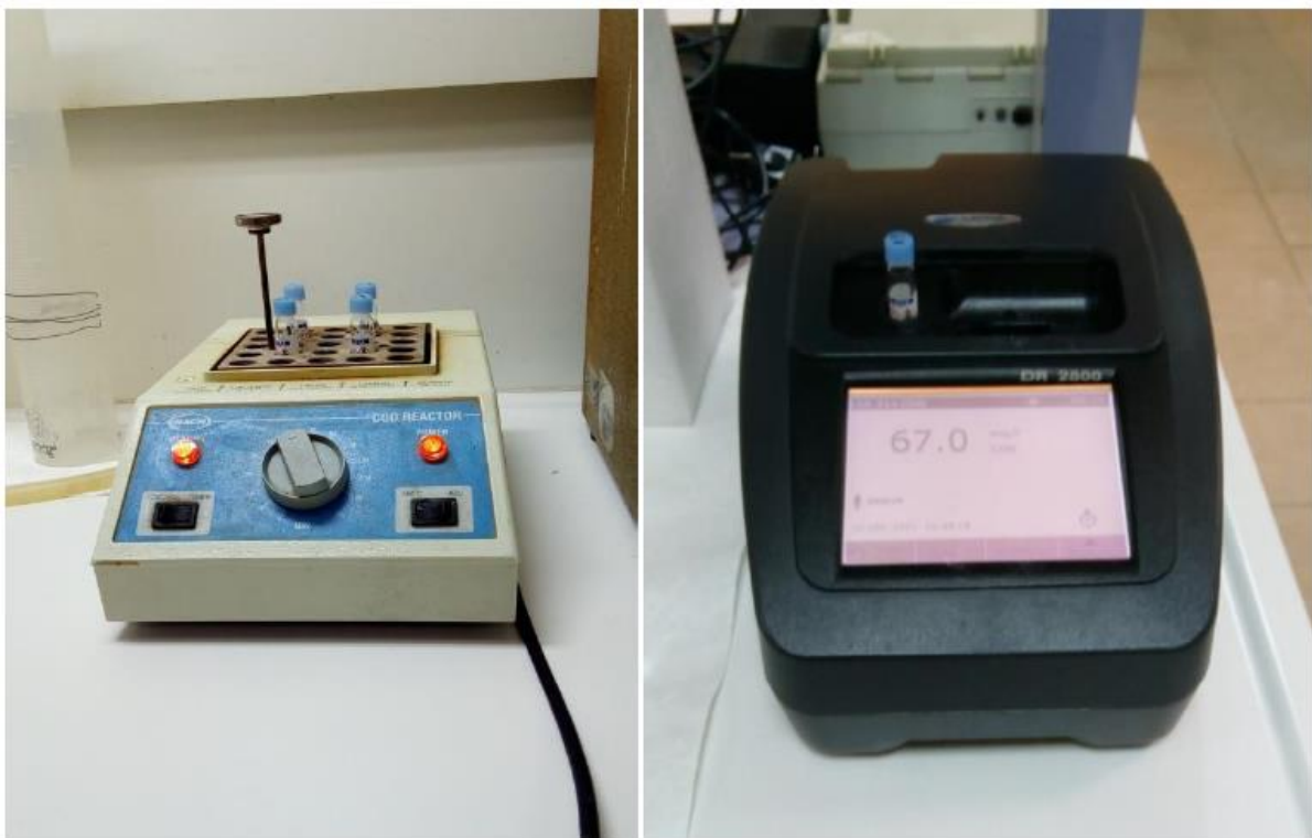
Σχήμα 14 Συσκευή χώνευσης με χρονοδιακόπτη και φασματοφωτόμετρο LANGE DR/2800 που χρησιμοποιήθηκαν για την μέτρηση του ολικού και διαλυτού COD
