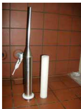
Εικόνα 6.1: Ειδικό έμβολο για το γέμισμα της κρεατόμαζας.
