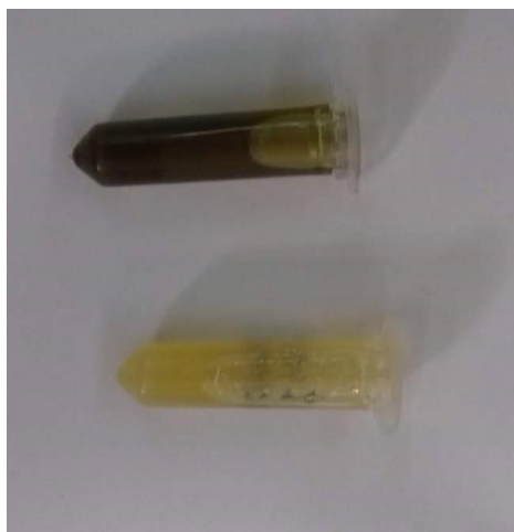
Εικόνα 5.2.1 : Δείγματα λαδιού chips πατάτας σε ependorf . Το σκούρο πράσινο αποτελεί δείγμα από συσκευασία με επίστρωση εκχυλίσματος οξικού αιθυλεστέρα ενώ το πιο ανοιχτό δείγματος αναφοράς.
