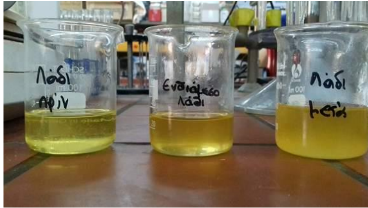
Εικόνα 4.4.4.2b: Μορφή φοινικελαίου στην αρχή, τη μέση και το τέλος του τηγανίσματος
