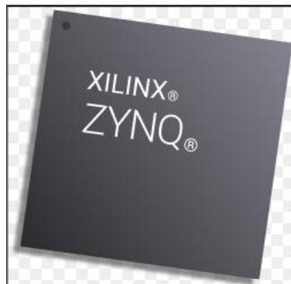
Σχήμα 3.1.1 :Το Xilinx Zynq-700 All Programmable SoC το οποίο περιέχεται στο Zybo.
