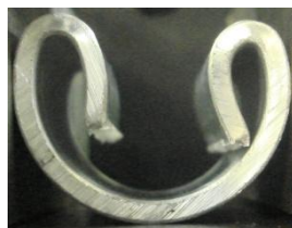
Εικόνα 2.2 Δοκίμιο 3 κατάρρευση σε ημιγωνία 90°
