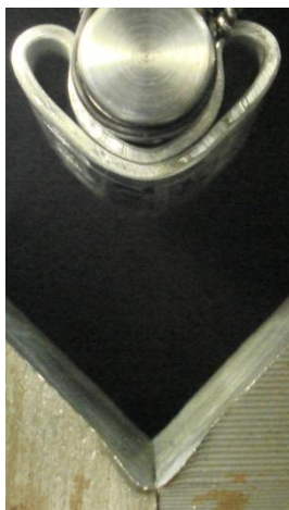
Εικόνα 2.4 Δοκίμιο 4 ημιγωνία 45° τελικό
