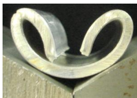
Εικόνα 2.1 Κατάρρευση Δοκιμίου 1 σε ημιγωνία 60^\circ
