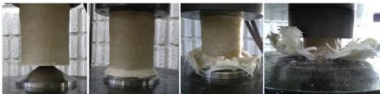
Εικόνα 1.10 Φάσεις πλαστικής απότμησης λόγω αξονικής φόρτισης
