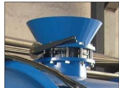
Εικόνα 5.4 : Θυρίδα τροφοδοσίας βιοαντιδραστήρα
