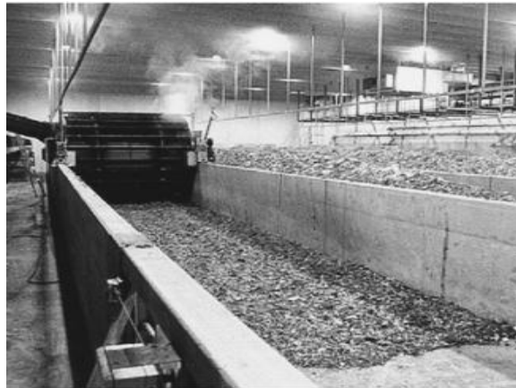
Εικόνα 3.11: Τυπική διάταξη οριζόντιων κλειστών συστημάτων κομποστοποίησης, τύπου καναλιών (Turovskiy and Mathai, 2006; Diaz et al., 2002)
