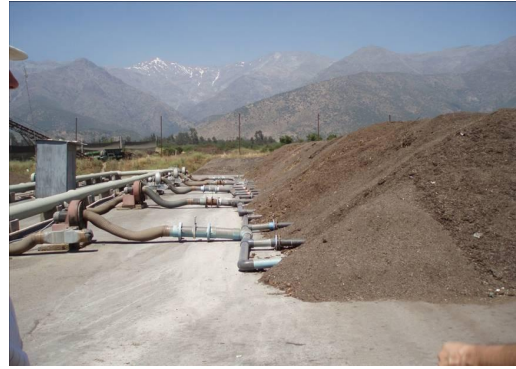
Εικόνα 3.14: Τυπική διάταξη οριζόντιου ανοιχτού συστήματος κομποστοποίησης, τύπου αεριζόμενων στατικών σωρών (Diaz et al., 2007, 2002)
