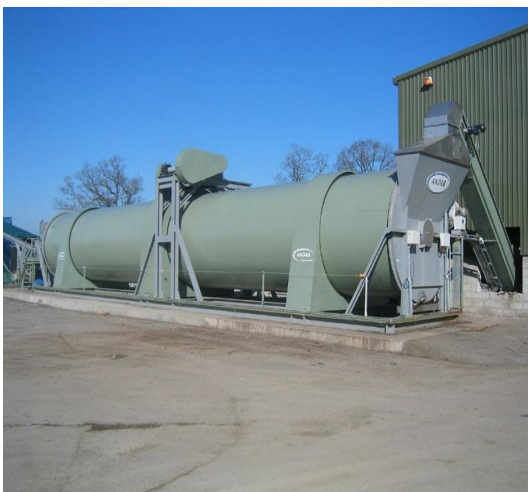
Εικόνα 3.12: Τυπική διάταξη οριζόντιου κλειστού συστήματος κομποστοποίησης, τύπου περιστρεφόμενου τυμπάνου (Diaz et al., 2002)
