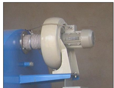
Εικόνα 5.7: Φυγοκεντρικός ανεμιστήρας απαγωγής αερίων εκπομπών
