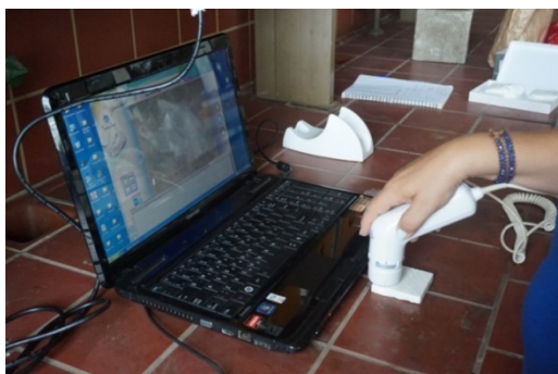
Σχήμα 18. Η διάταξη μικροσκοπίας οπτικών ινών (FOM) που χρησιμοποιήθηκε για την εξέταση των δοκιμίων
