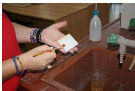
Μετά από 48 ώρες όλα τα δοκίμια ξεπλύθηκαν προσεκτικά με άφθονο απιονισμένο νερό και μαλακό πινέλο.
