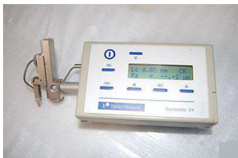
Σχήμα 20. Το τραχύμετρο Surtronic 3+ (αριστερά) και το μετακινούμενο στέλεχος (αισθητήρας) (δεξιά)
