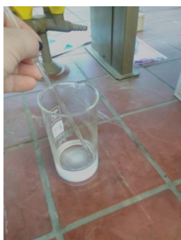
Κατά την παρασκευή του διαλύματος οξαλικού αμμωνίου με προσθήκη αιθανόλης.
