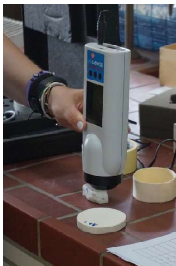
Σχήμα 22. Διαδικασία χρωματομέτρησης με το φασματοφωτόμετρο DoctorLangLM6 159.
