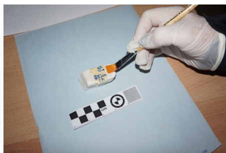
Εφαρμογή σύνθεσης οξαλικού αμμωνίου με βούρτσισμα
