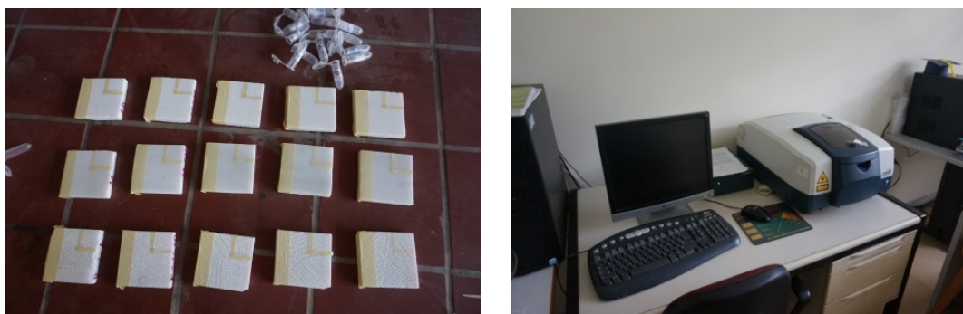
Σχήμα 27. Η οριοθέτηση των τμημάτων των δοκιμίων απ' όπου λήφθηκε δείγμα σκόνης (αριστερά), το όργανο JASCOFTIR 4200 (δεξιά).
