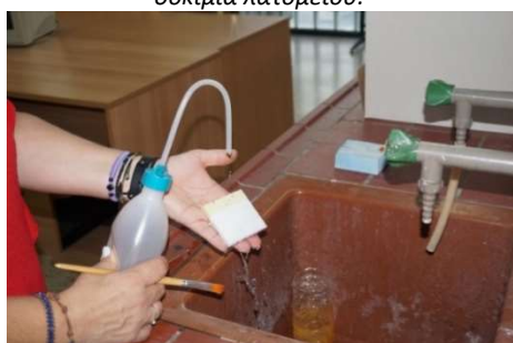
Μετά από 48 ώρες όλα τα δοκίμια ξεπλύθηκαν προσεκτικά με άφθονο απιονισμένο νερό και μαλακό πινέλο.
