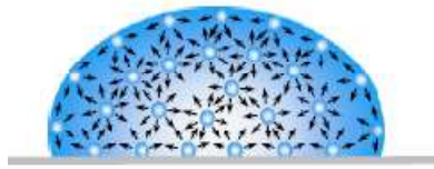
Σχήμα 24. Η επιφανειακή τάση προκαλείται από τις μη ισορροπημένες δυνάμεις υγρών μορίων στην επιφάνεια.
