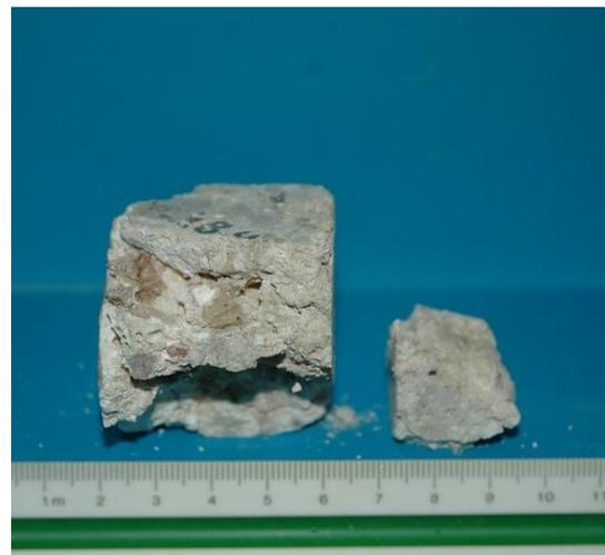
**Εικόνα IV.35:** Εικόνες του δοκιμίου NP\_3B\_4 μετά τη δοκιμή της μονοαξονικής θλίψης
