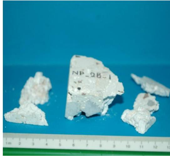
**Εικόνα IV.30:** Εικόνες του δοκιμίου NP\_2B\_1 μετά τη δοκιμή της μονοαξονικής θλίψης
