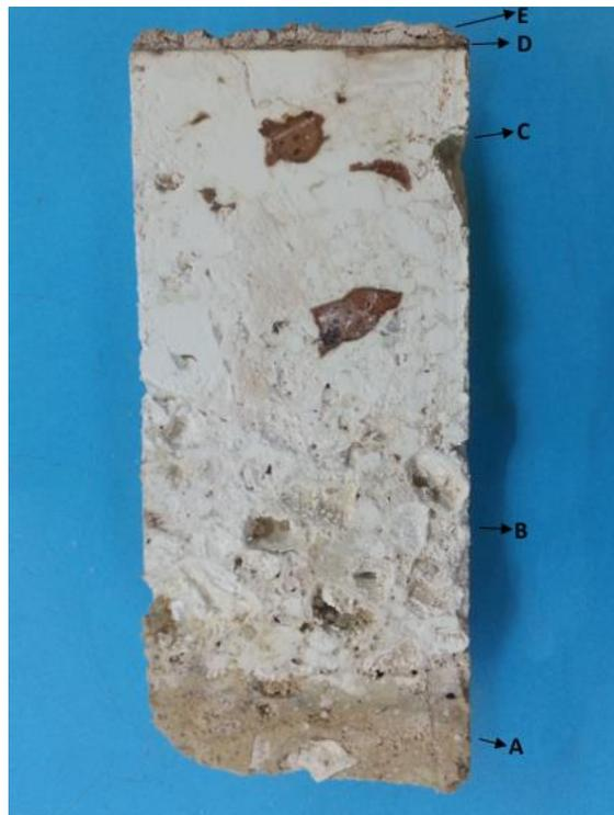
**Εικόνα III.5:** Κωδικοποίηση διαστρωμάτωσης σκυροδέματος
