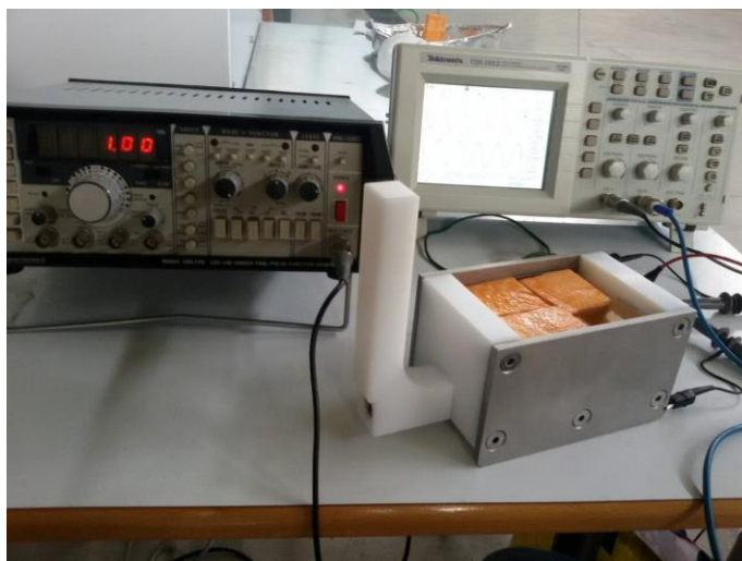
Εικόνα 4.1. Η γεννήτρια συχνοτήτων Newtronics 200LTPC (αριστερά) και ο παλμογράφος Tektronix TDS1012 (δεξιά).
