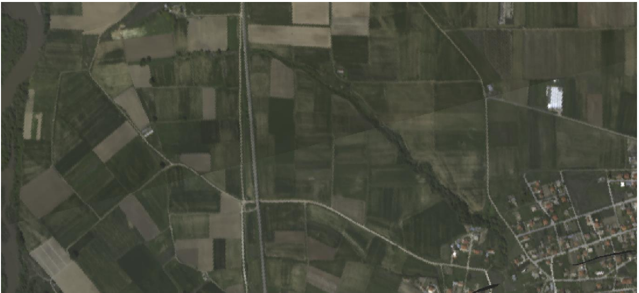
Εικόνα 4.1. : Φυσικό έγχρωμο σύνθετο RGB (30,25,15) για την υπερφασματική εικόνα κοντά στη περιοχή του ποταμού Αξιού (Εικόνα 1)
