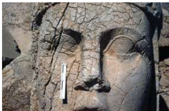
Εικόνα 1.2.2.6: Μικρορηγματώσεις σε κεφάλι αγάλματος του Απόλλωνα (Τουρκία, NemrudDag 2002, Γεωλογικό Ινστιτούτο Πανεπιστημίου του Aachen / B. Fitzner)
