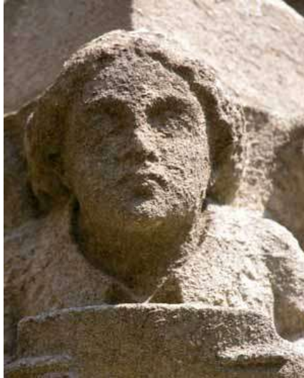
Εικόνα 1.2.2.8: Απομείωση λεπτομερειών αγάλματος από την όξινη βροχή
